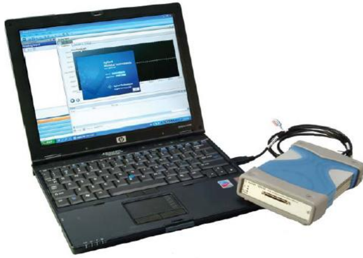
Şekil 6.5. U2352A Modüler çok fonksiyonlu veri toplama cihazı
