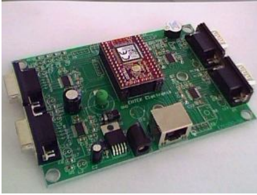
Şekil 5.4. Seri – Ethernet çevirici entegresi
