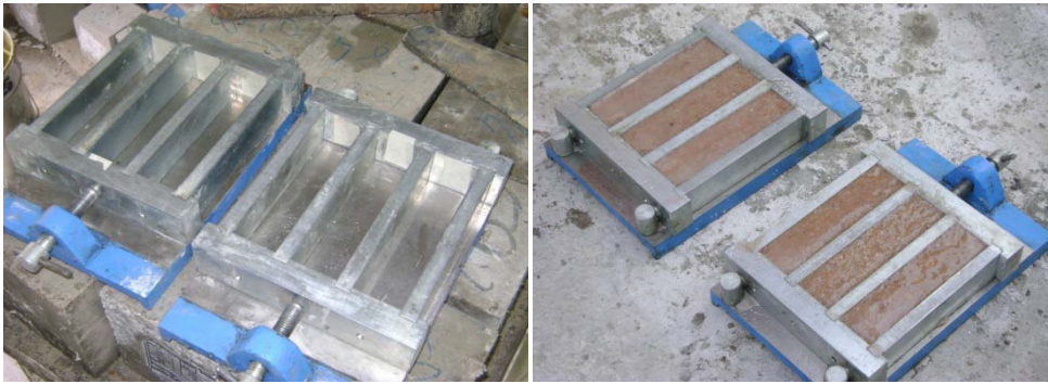
Şekil 5.2. Prizmatik numune kalıpları
