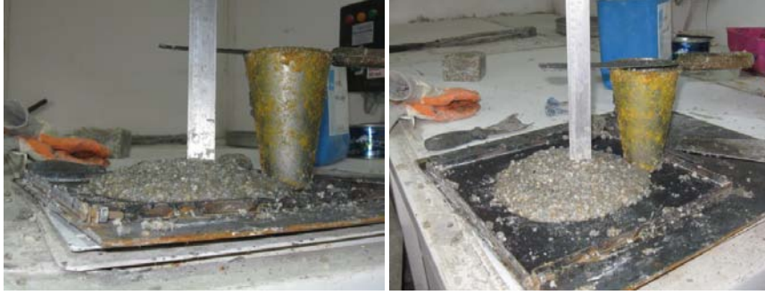
Şekil 5.27. KN2 CT4 (çökme:13,5 cm) ve KN2 CT5 (çökme:14,5cm) ait çökme değerleri
