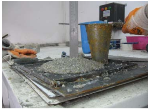
Şekil 4.1. Taze harcın işlenebilirlik deneyi
