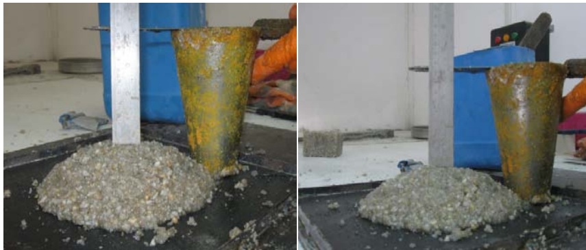
Şekil 5.26. KN2 CT2 (çökme:11 cm) ve KN2 CT3 (çökme:12cm) ait çökme değerleri
