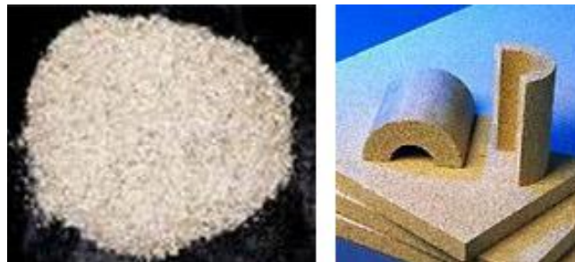
Şekil 5.22. Genleştirilmiş vermikülit ürünler
