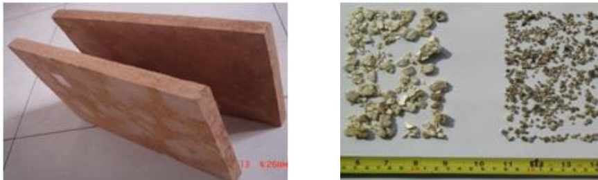
Şekil 5.21. Vermikülit yalıtım malzemesinin tanecikli hali ve levha hali
