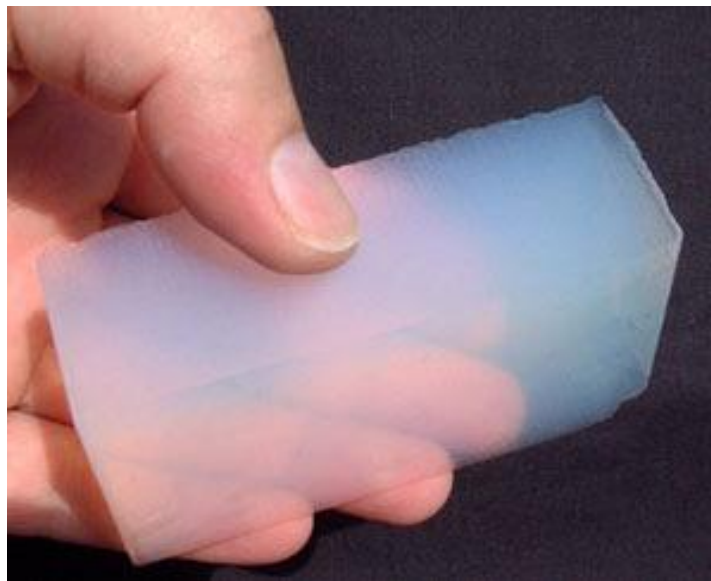
Şekil 5.39. İçinde çok küçük ve milyonlarca boşluk bulunduran dünyanın var olan en hafif katı maddesi silika aerojel
