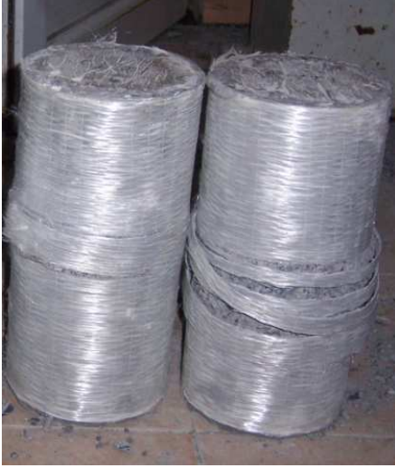
Şekil 5.39. C1-2D kodlu deney numunelerinin deney sonucunda kırılmış hali
