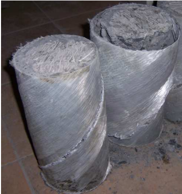
Şekil 5.51. C2-1D+1E kodlu deney numunelerinin deney sonucundaki şekil değiştirmiş hali
