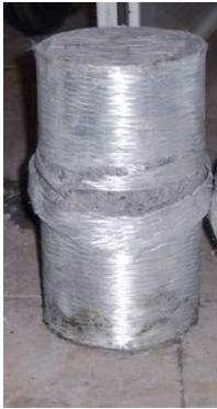
Şekil 5.37. C1-1D kodlu deney numunelerinin deney sonucundaki kırılmış hali
