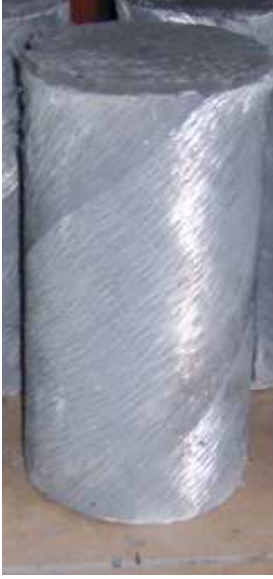
Şekil 5.63. C3-1D+2E kodlu deney numunelerinin deney sonucundaki şekil deęiřtirmiř hali
