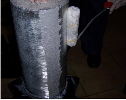
Şekil 5.30. Silindir numunelerin etrafındaki olası hava kabarcıkların rulo ile alınması
