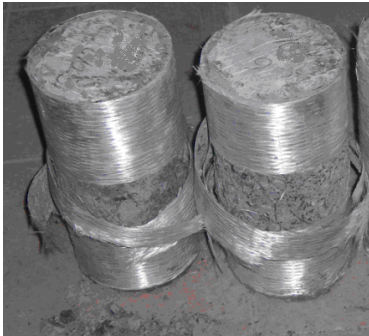
Şekil 5.57. C3-1D kodlu deney numunelerinin deney sonucundaki şekil değiştirmiş hali
