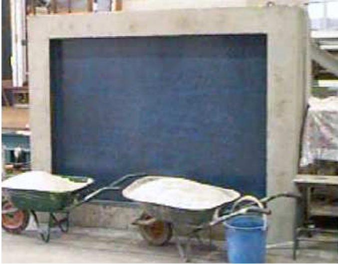
Şekil 4.7. Dolgu duvarların LP sargı ile güçlendirilmesi
