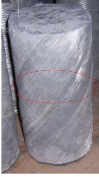
Şekil 5.43. C1-1D+2E kodlu deney numunelerinin deney sonucundaki şekil değiştirmiş hali
