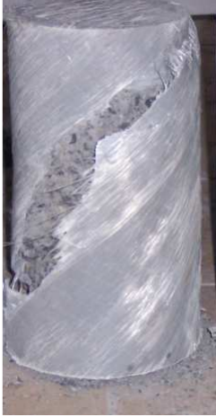
Şekil 5.61. C3-1D+1E kodlu deney numunelerinin deney sonucundaki şekil değiştirmiş hali
