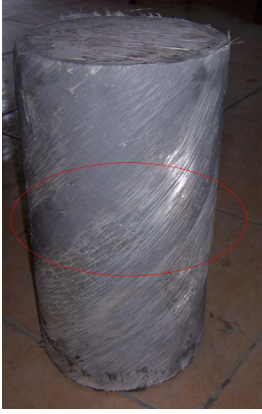
Şekil 5.53. C2-1D+2E kodlu deney numunelerinin deney sonucundaki şekil değiştirmiş hali
