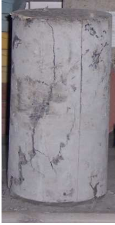
Şekil 5.45. C2-Ş.N kodlu deney numunelerinin deney sonucundaki şekil deęiřtirmiş hali
