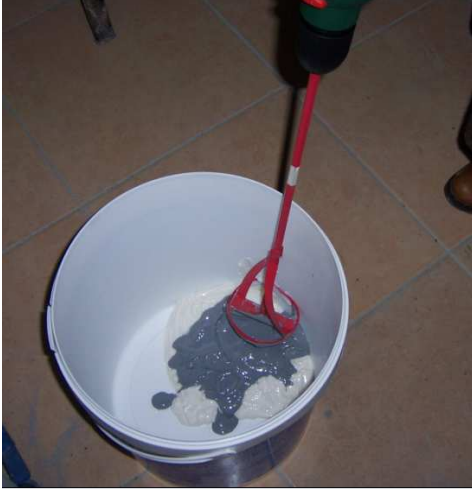
Şekil 5.26. Sikadur 330 A-B bileşenlerinin karışıma başlamadan önceki hali
