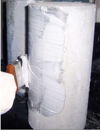
Şekil 5.28. Silindir numunelerin etrafındaki mevcut boşlukların epoksi harç ile kapatılması
