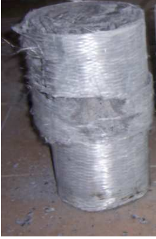
Şekil 5.59. C1-2D kodlu deney numunelerinin deney sonucundaki şekil değiştirmiş hali
