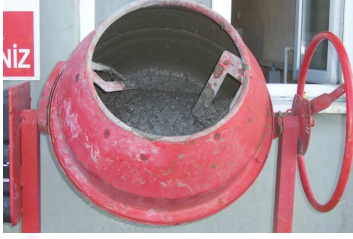
Şekil 5.20. Mikserde karıştırılan beton
