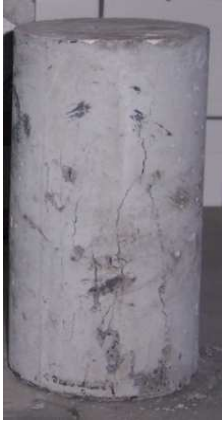
Şekil 5.35. Şahit numunenin deney sonucunda kırılmış hali
