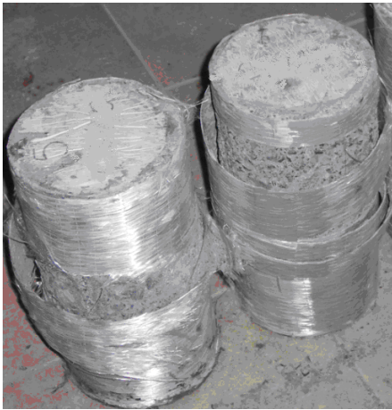
Şekil 5.47. C2-1D kodlu deney numunelerinin deney sonucundaki şekil değıştirmiş hali
