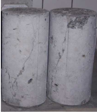
Şekil 5.55. C3-Ş.N kodlu deney numunelerinin deney sonucundaki şekil değiştirmiş hali
