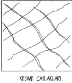
Şekil 2.22. Betonarme perdelerdeki kesme çatlakları
