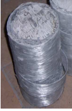
Şekil 5.49. C2-2D kodlu deney numunelerinin deney sonucundaki şekil değiştirmiş hali
