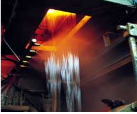
Şekil 5.2. Cam elyaf ham maddelerinin yüksek sıcaklıkta sıvı hale geçmesi
