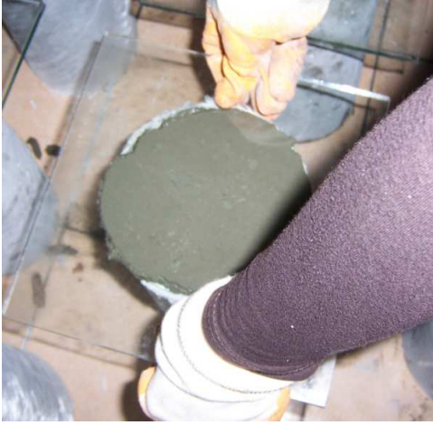
Şekil 5.31. Çimento başlık üzerine cam plaka uygulaması
