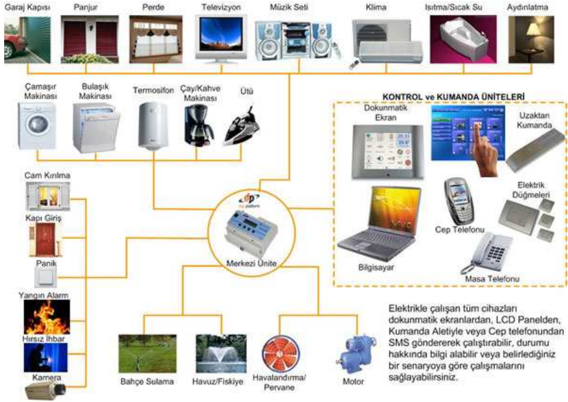
Şekil 2.2. Akıllı bina sistemi kontrol diyagramı
