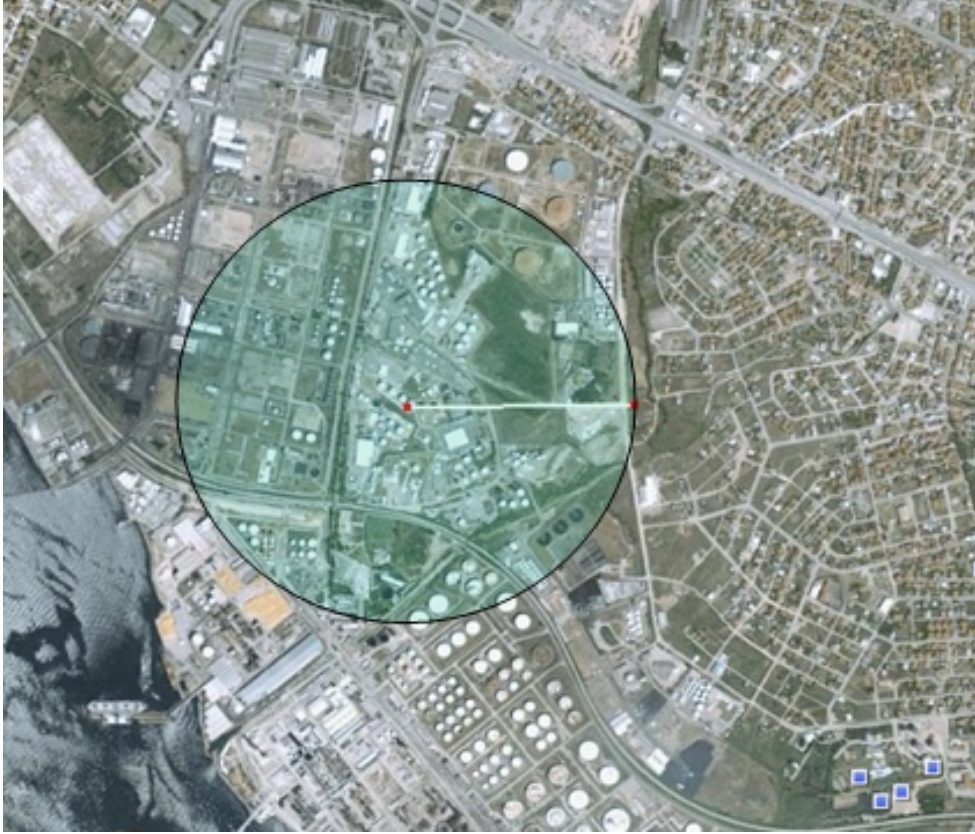
Şekil 4.13. 5000 m 3 LPG Tankının Patlaması Etki Mesafesinin Harita Üzerinde Görünümü
