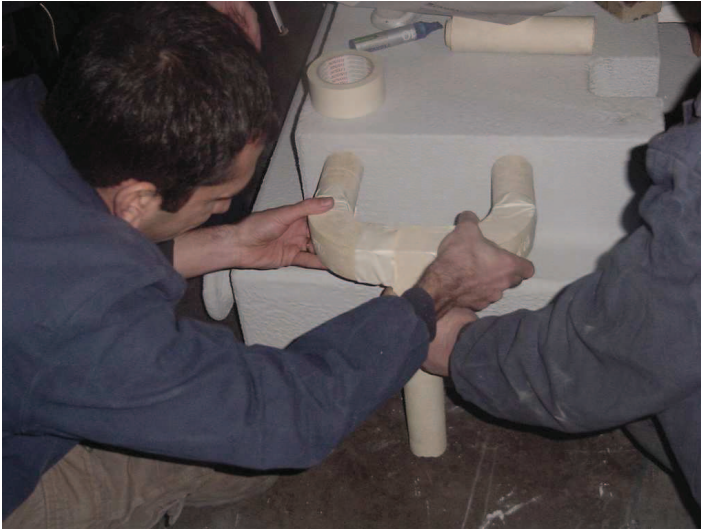
Şekil 5.13. Strafor model üzerine çelik bölgeye seramik yolluk montajı.
