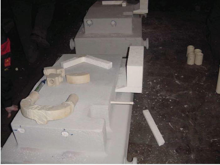
Şekil 5.12. Strafor model üzerine SSO ve termokupul montajı.
