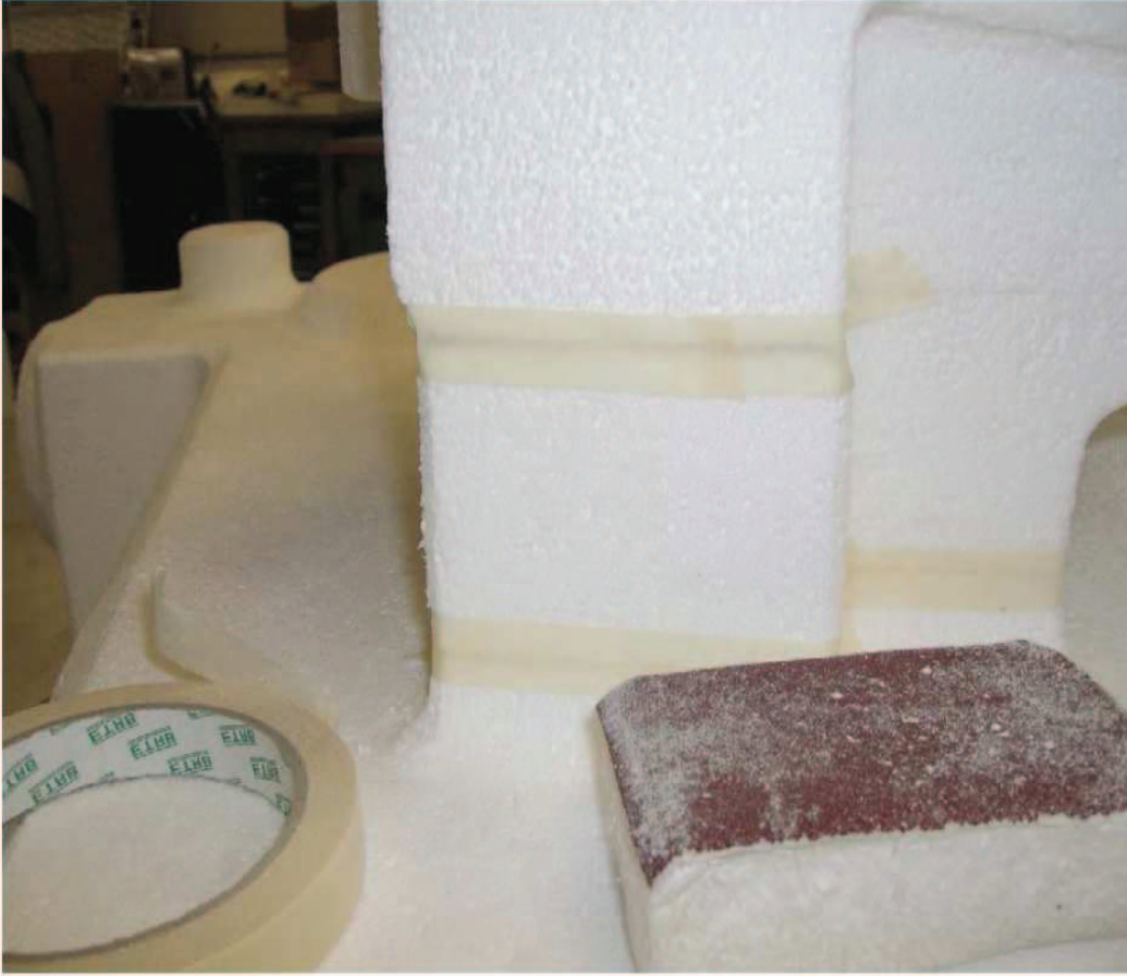
Şekil 4.6. Arayüzey çizgisi boyunca köpük modellerin şerit bant ile yapıştırması
