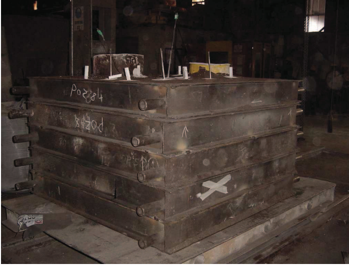
Şekil 5.16. Bimetal dökümün derece ile kalıplanması.
