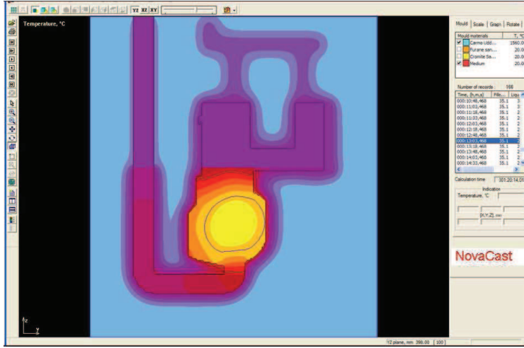
Şekil 3.76. Sıcaklık seçilerek parçanın kesit görünüşünde sıcaklık dağılımının kontrolü
