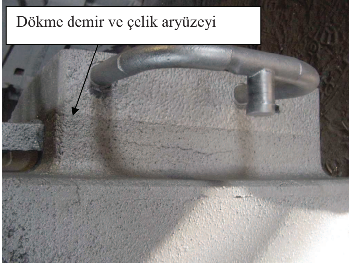
Şekil 5.18. Bimetal dökümdeki çelik ve dökme demir arayüzü.
