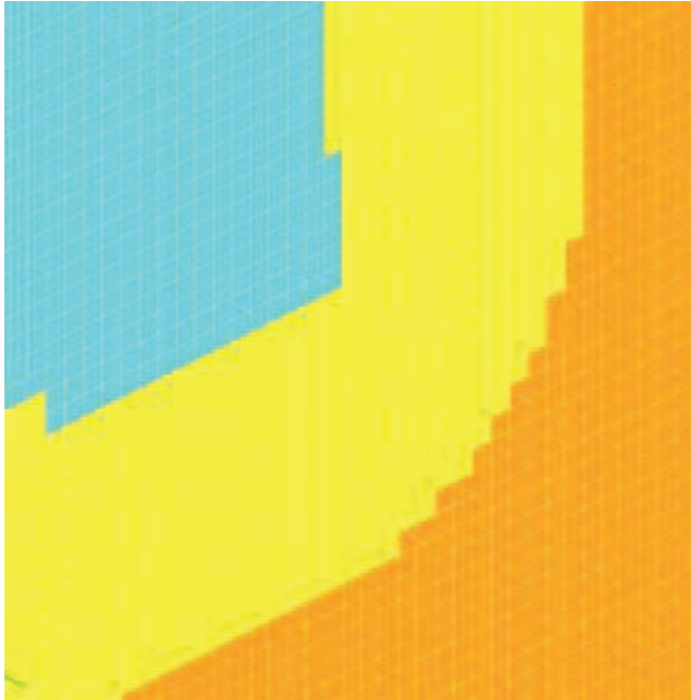
Şekil 3.45 Büyütülen bölgedeki hücre sayısı görüntüsü ile en küçük kesitte hücre sayısının 3x3 den az olmadığını kontrolü
