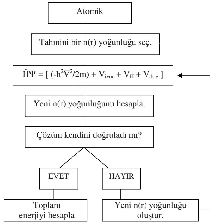
Şekil 2.1. Bir kristalin toplam enerjisini kendini doğrulama metodunu kullanarak hesaplayan bir bilgisayar programının akış çizelgesi
