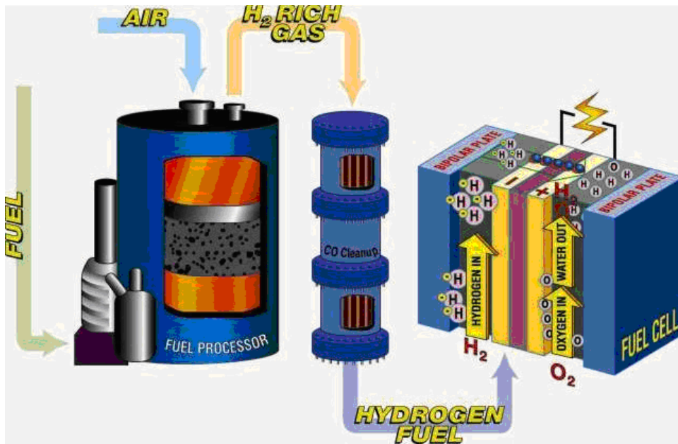
Şekil 2.14. Yakıt pili içyapısı ve elektrik enerjisi üretim prensibi [10]
