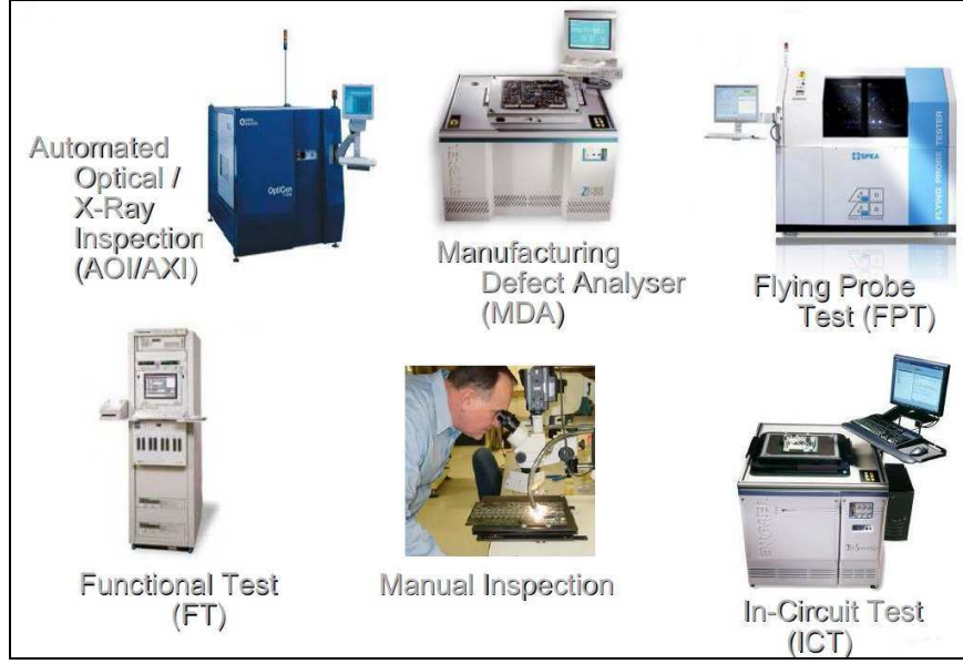
Şekil 3.1. Elektronik devre kartı test düzenekleri
