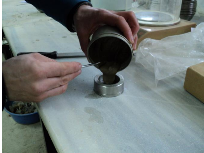
Foto 4.6. Büzülme potasına numune doldurma
