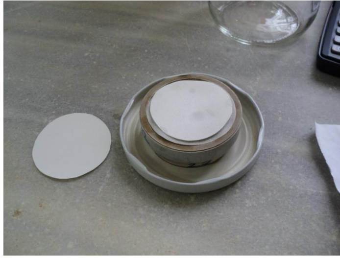
Foto 4.10. Filtre kağıtlarının hazırlanması
