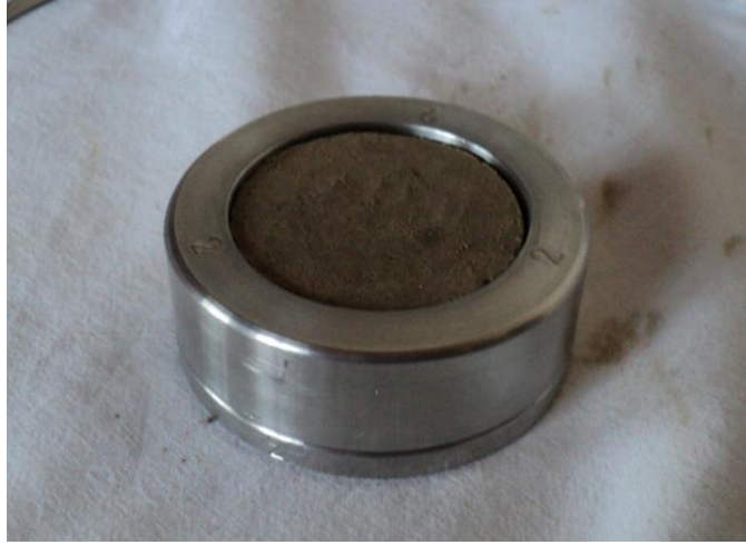
Foto 4.8. Büzülme potasından çıkarılacak numune
