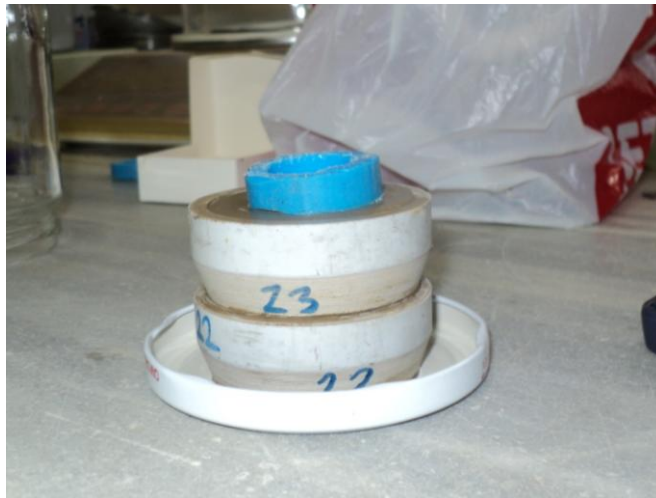
Foto 4.11. Kılcal gerilme ölçümü (Sandviç şeklinde hazırlanan filtre kağıtlarının zemin numunelerinin arasına yerleştirilmesi)
