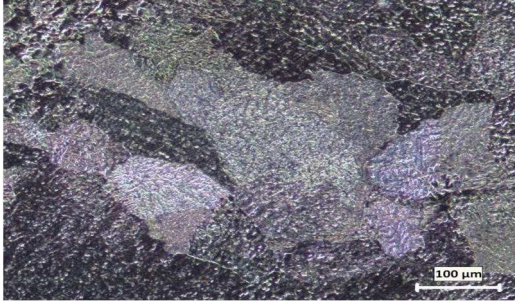
3.ITAB'da tane irileşmesi (100X)
