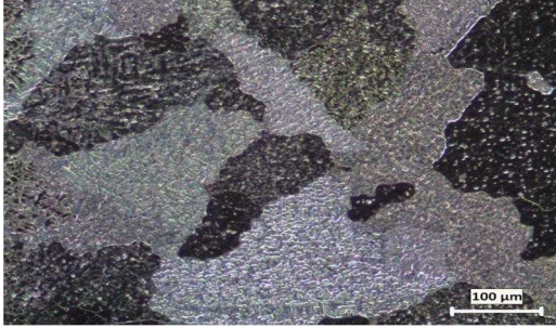
3.ITAB'da tane irileşmesi (100X)
