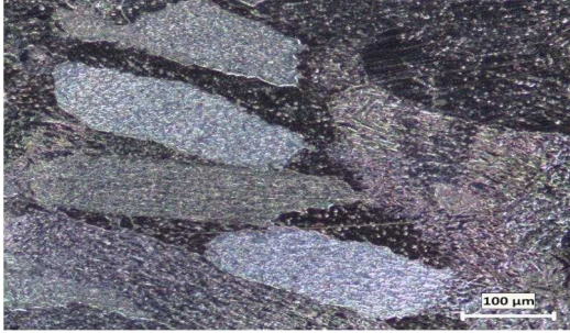
3.ITAB'da tane irileşmesi (100X)
