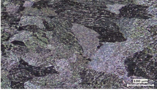
3.ITAB'da tane irileşmesi (100X)
