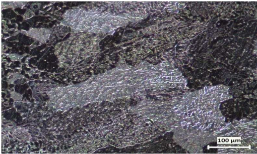
3.ITAB'da tane irileşmesi (100X)
