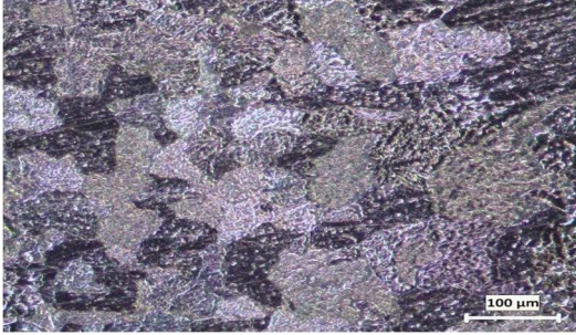
3.ITAB'da tane irileşmesi (100X)
