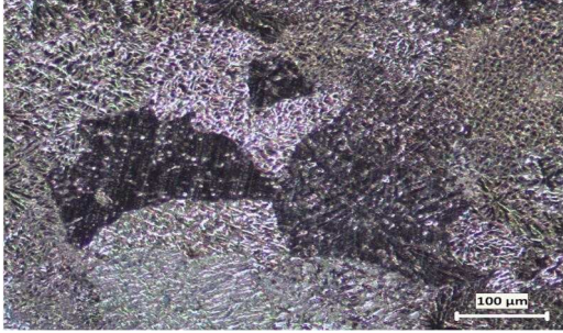
3.ITAB'da tane irileşmesi (100X)
