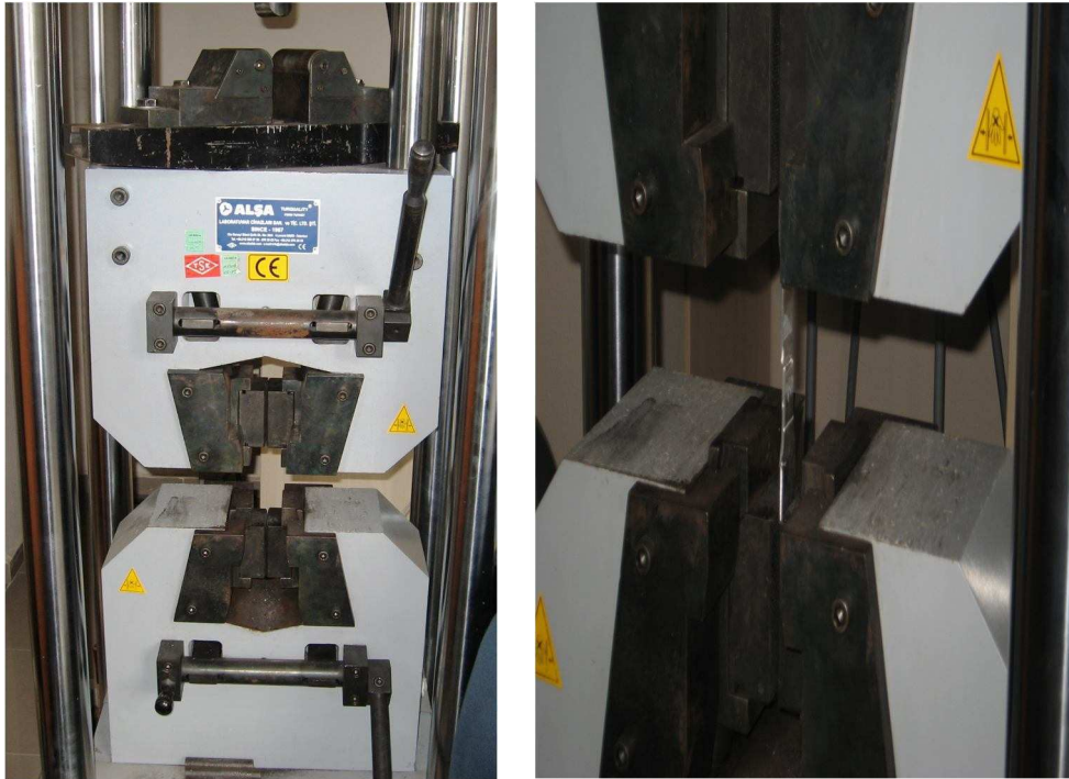
Şekil 4.2. Çekme deneyi makinesi ve çekilen numune
