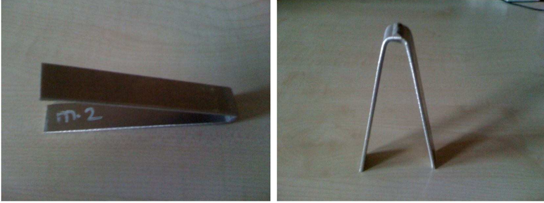
Şekil 5.22. Eğme deneyine tabi tutulmuş numuneler
