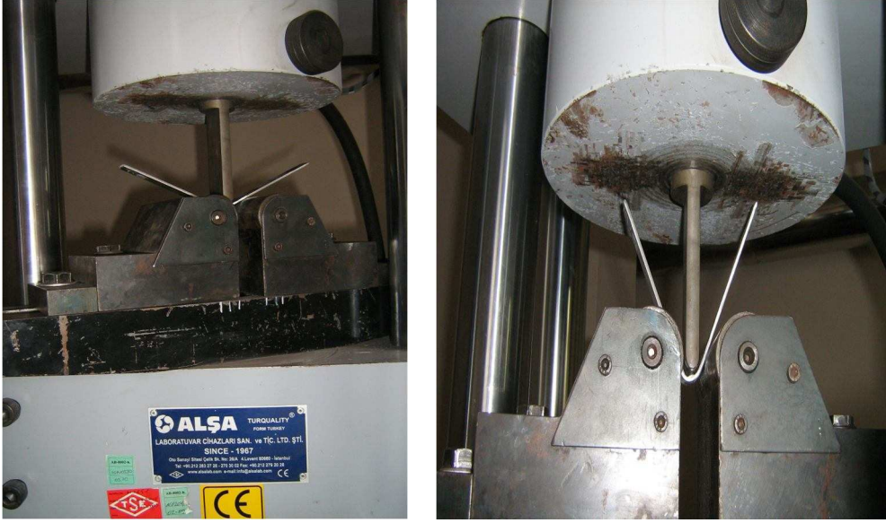
Şekil 4.5. Eğme deney makinesi ve eğilen numune
