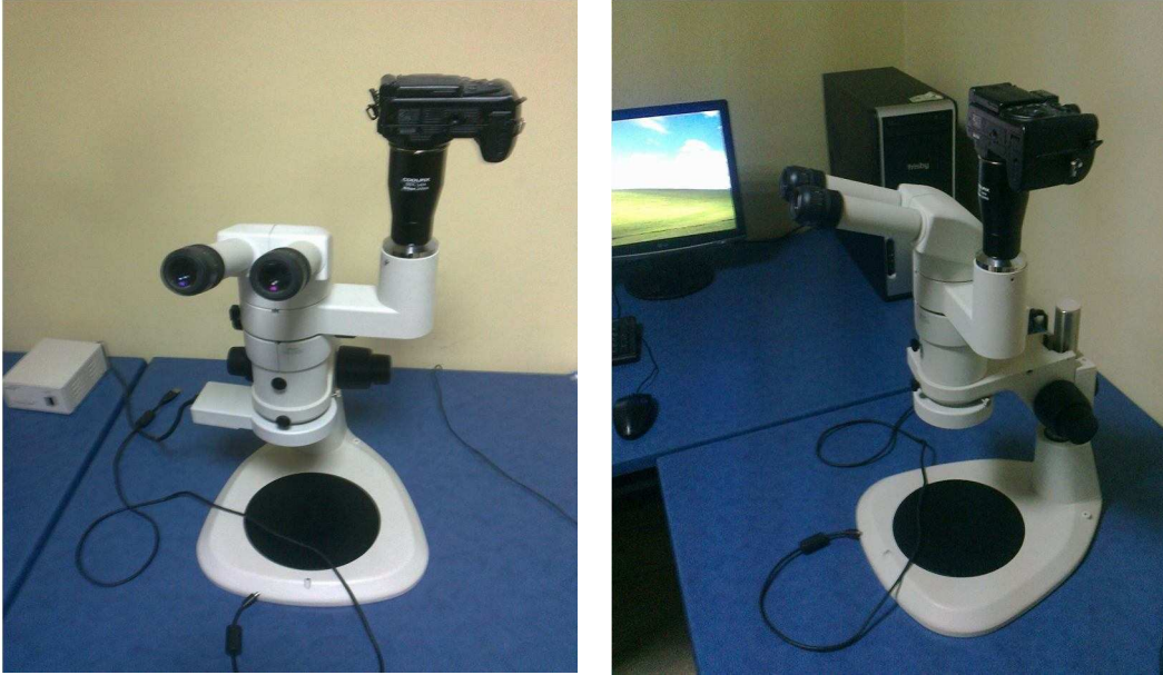
Şekil 4.8. Makro görüntü alma cihazı
