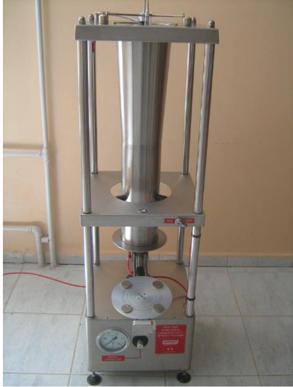
Şekil 3.16. Yaprak disklerini ilaçlamada kullanılan ilaçlama kulesi
