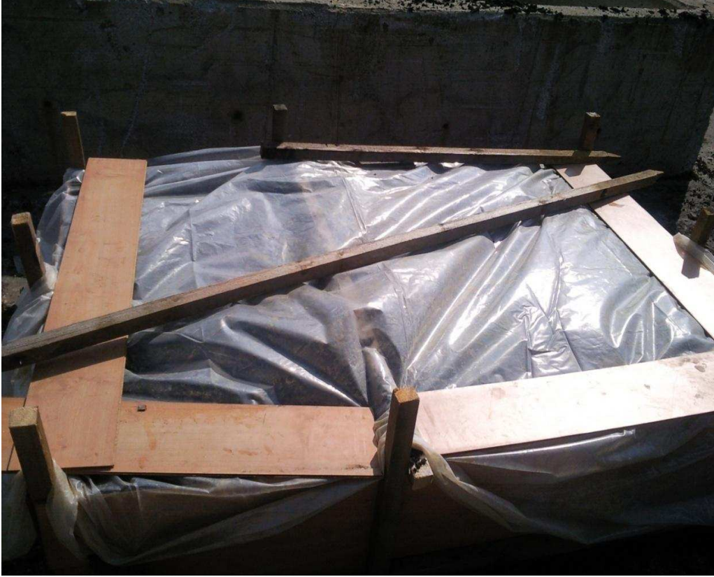
Şekil 3.2. Solarizasyon uygulaması için gerekli olan arıtma çamurunun dökülülerek polietilen naylon ile hava almayacak şekilde kapatılması
