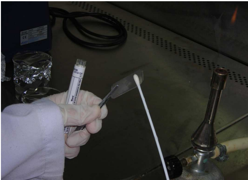
Şekil 3.3. Paslanmaz çelik plakaları swaplama tekniği
