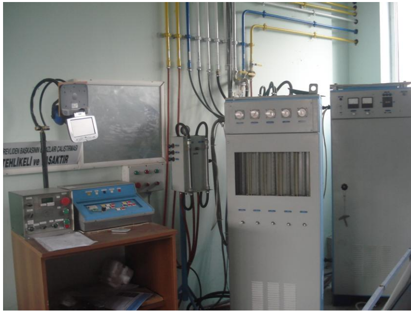
Şekil 5.1. a)Pulse plazma uygulama sistemi (plazmatron), b) kontrol paneli ve güç üniteleri
