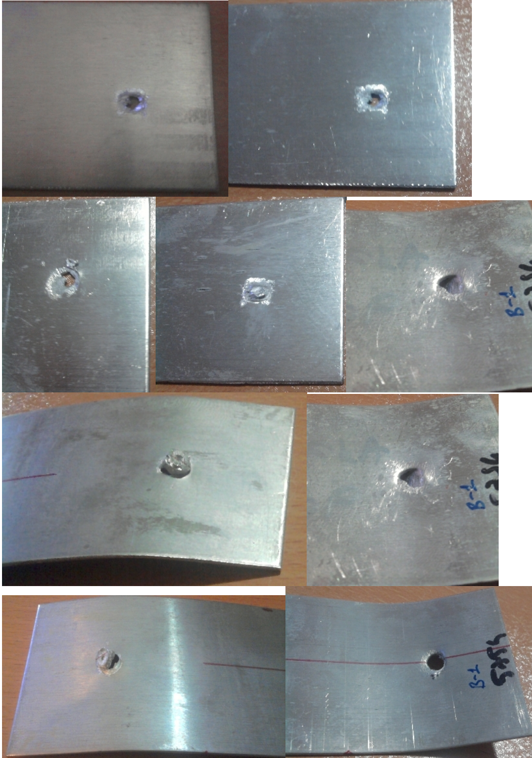
ekil 6.1.Çekme makaslama testinde ortaya çıkan kopma türlerine örnekler
