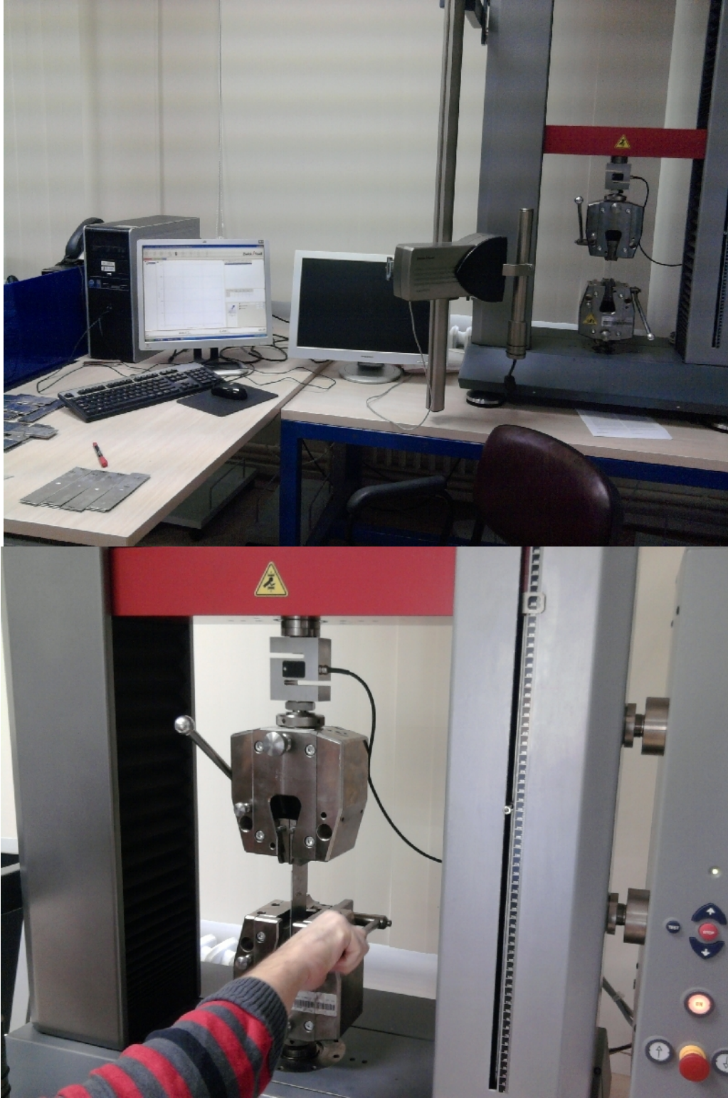
ekil 5.10 Zwick/Roell marka çekme cihazı ve çekme testlerinin yapılı 1
