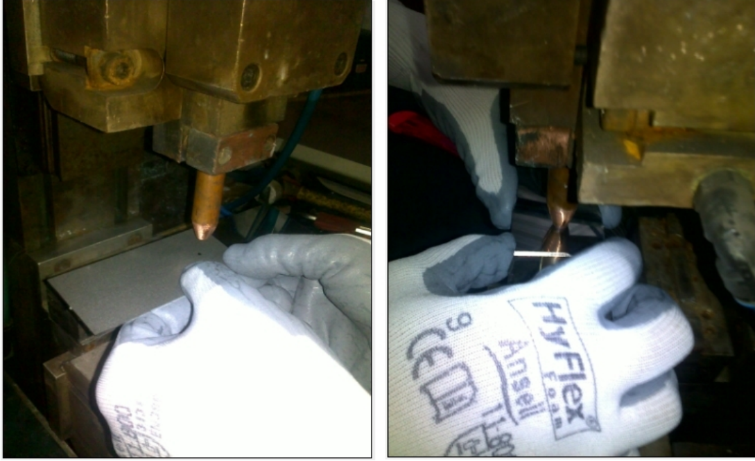
Şekil 4.4. Elektrik direnç nokta kaynak işleminin gerçekleştirilmesi
