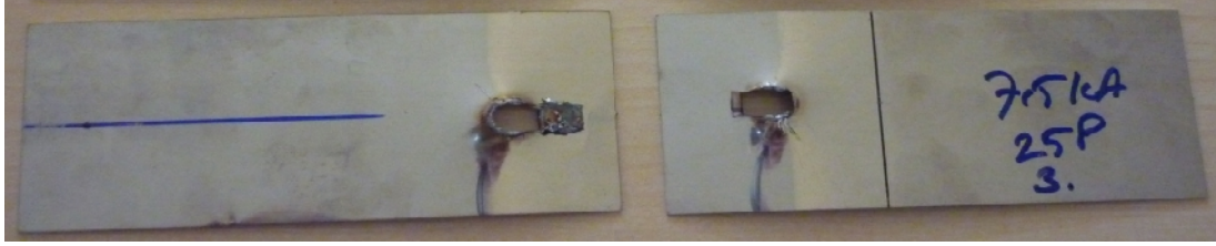
Şekil 5.1. 7.5 kA kaynak akım şiddeti, 25 P kaynak zamanında ferritik-ferritik parçalarda sac arayüzünde oluşan fişkıma ve çirkin elektrot izleri
