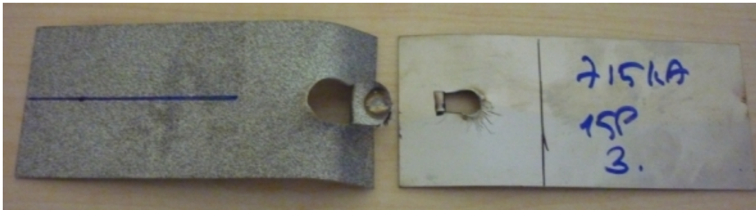
Şekil 5.2. 7.5 kA kaynak akım şiddeti, 15 P kaynak zamanında ferritik-ostenitik parçalarda çekme-makaslama deneyinde ferritik parçalarda görülen çekirdek dibinden yırtılma
