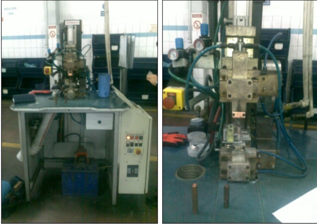
Şekil 4.3. Kaynaklı bağlantıların yapıldığı elektrik direnç nokta kaynak makinesi
