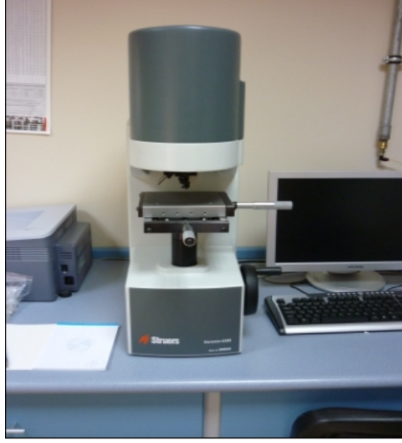
Şekil 4.10. Mikrosertlik ölçümünde kullanılan vickers ölçüm cihazı (Struers)
