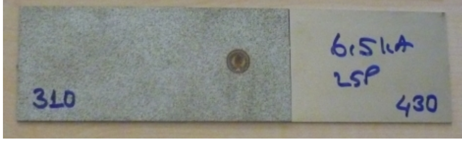
Şekil 4.2. Elektrik direnç nokta kaynağı ile birleştirilmiş deney numunesi
