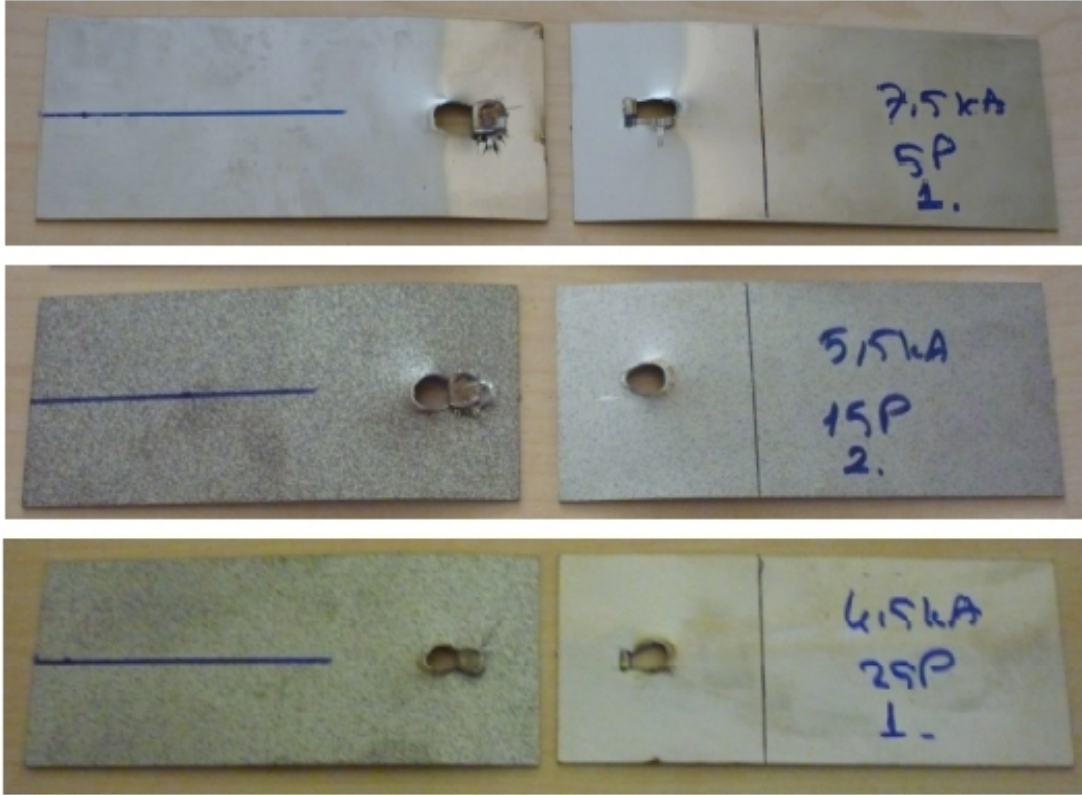
Şekil 5.13. Düğme tipi kopma görüntüleri
