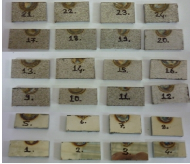
Şekil 4.12. Metalografik incelemeler için kesilen parçaların bakalite alınmadan önceki görüntüsü
