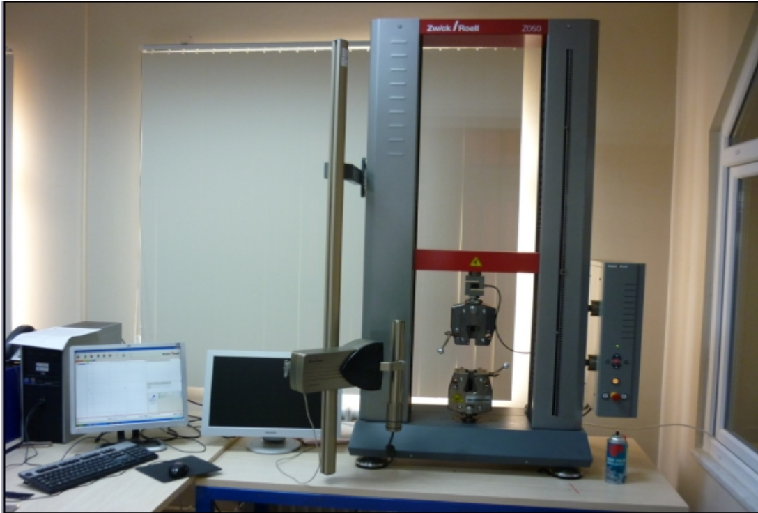
Şekil 4.8. Çekme test cihazı ve donanımı
