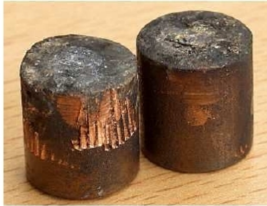
Şekil 3.10. Elektrot uçlarında mantarlaşıma [47]
