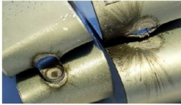
Şekil 3.17. Nokta kaynağında düğmelenme yoluyla hasar [48]
