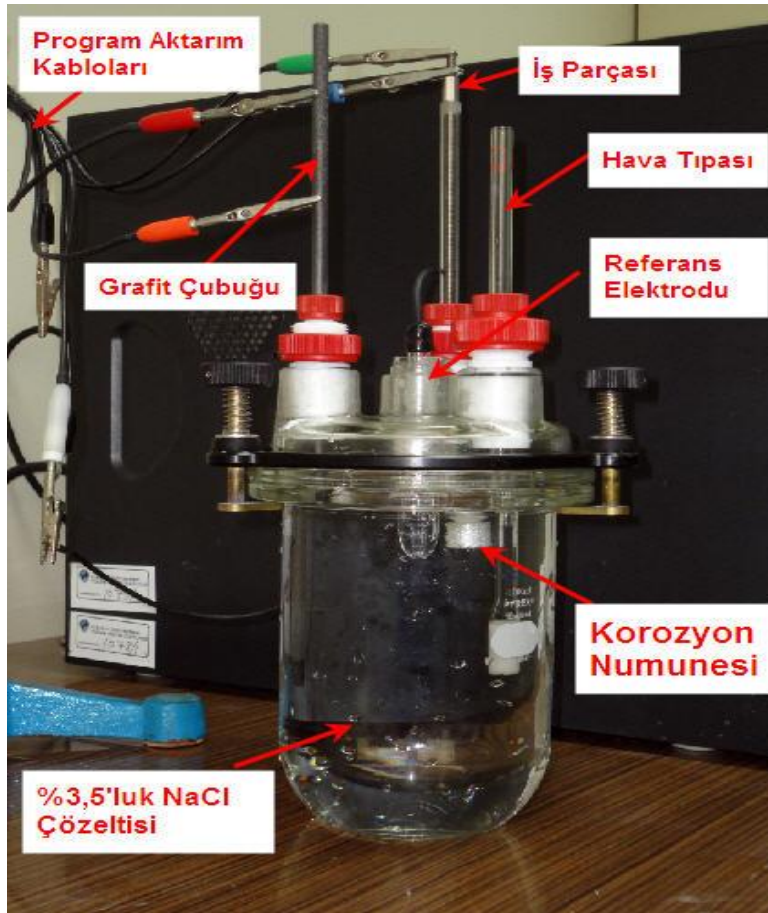
Şekil 4.20. Korozyon deneyi ekipmanları
