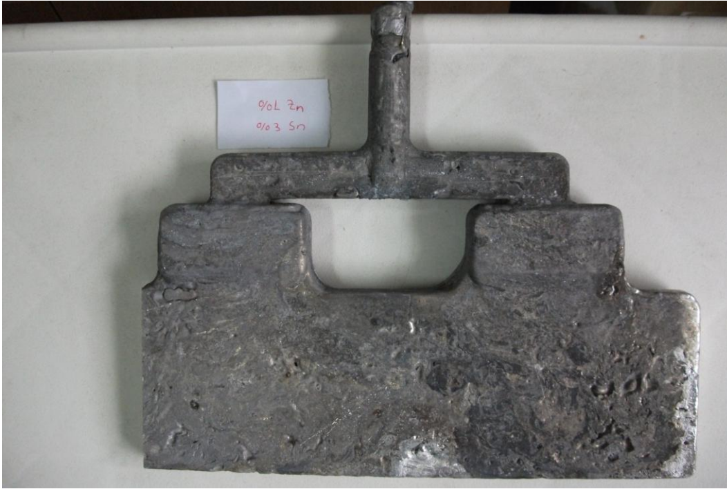
Şekil 4.9. Üretilen saf magnezyum+%1Zn+%3Sn alaşımının fotoğraf görüntüsü
