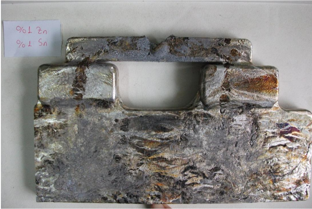
Şekil 4.8. Üretilen saf magnezyum+%1Zn+%1Sn alařımının fotoğraf görüntüsü
