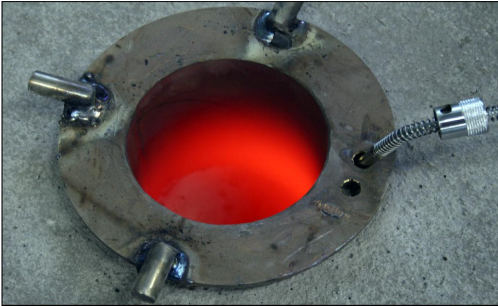
Şekil 4.6. Kurulan fırın sisteminde potanın fotoğraf görüntüsü
