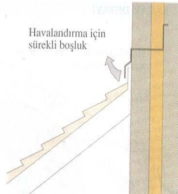
Şekil 4.16. Tek eğimli çatılarda havalandırma [17]
