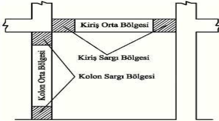
Şekil 2.3. Kolon ve kiriş elemanlarda sargılama bölgeleri [18]
