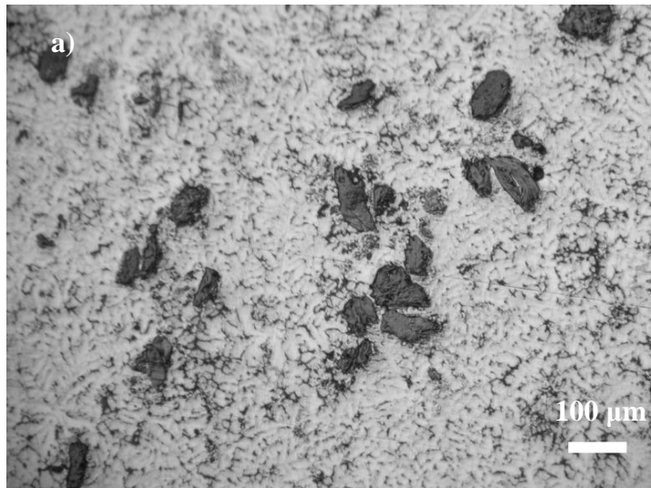
Şekil 6.4.a-b) %5 grafit takviyeli kompozitin döküm hali, c-d)ısıtılma sonrası mikroyapı resimleri.
