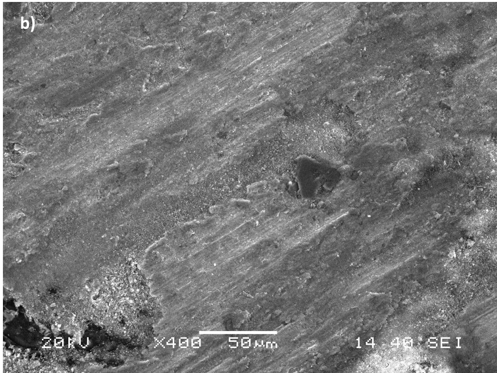
Şekil 6. 52. a) Döküm %10 SiC ve %10 grafit takviyeli kompozit malzemenin 0,5 m/s kayma hızında, b) ısıtılmış %10 SiC ve %2,5 grafit takviyeli (HKM) kompozit malzemenin 2/s hızda aşınma yüzeyleri.
