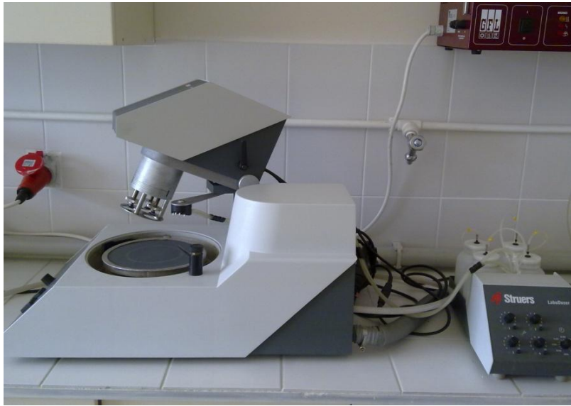
Şekil 5.4. Zımparalama ve parlatma işleminin yapıldığı STRUERS LABOPOL-25 cihazı.
