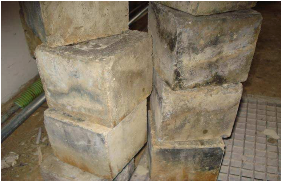
Şekil 4.9. Havuzlardan 6 ay sonra çıkarılan numunelerin durumu
