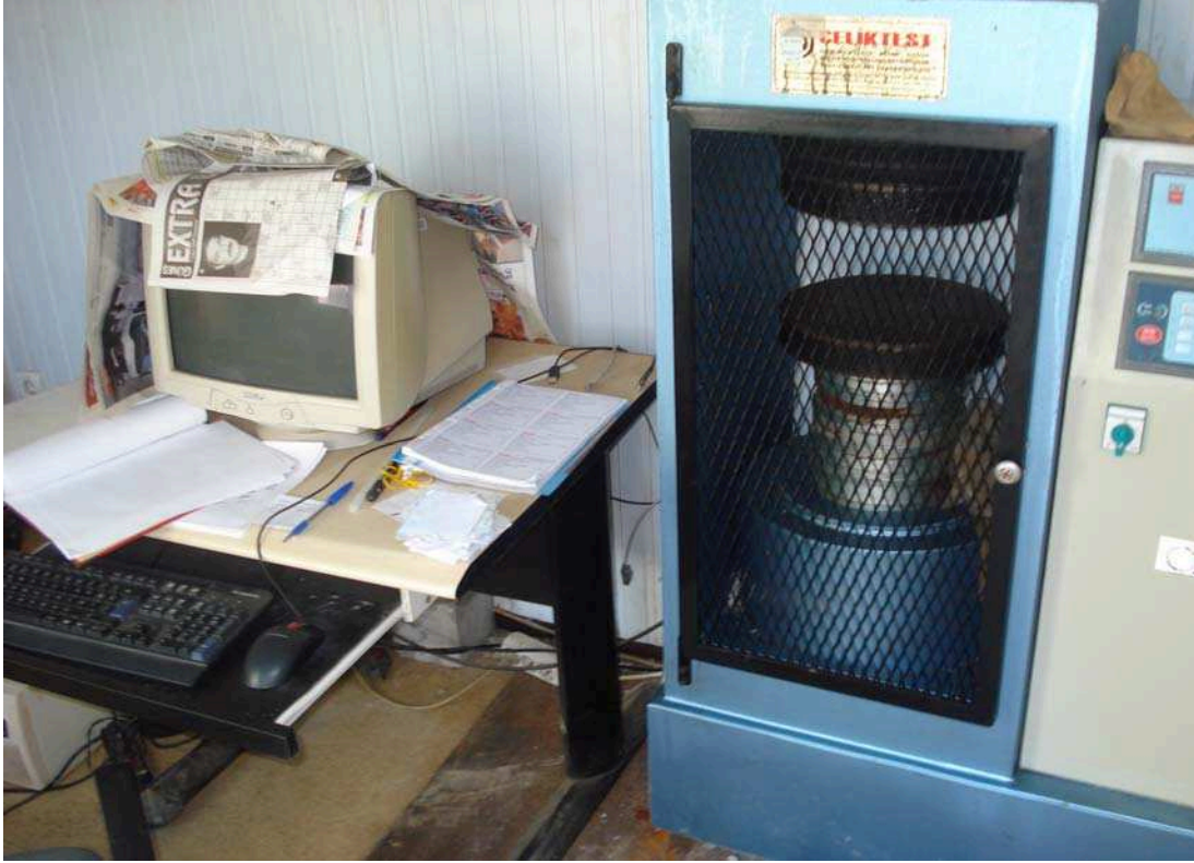
Şekil 4.8. Numunelerin basınç dayanımlarının ölçülmesi
