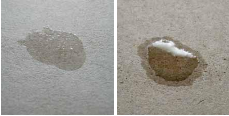
Resim 4. Uygulama yüzeyinin yüzey emiciliği
