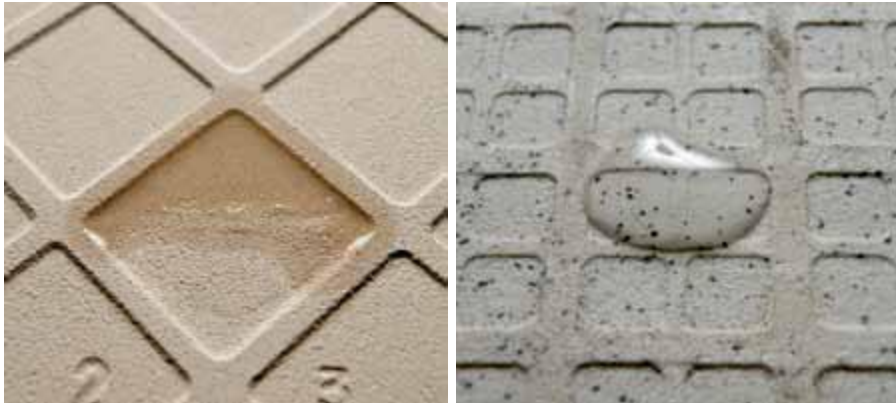
Resim 3. Kaplama malzemesinin yüzey emiciliği
