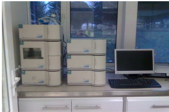
Şekil 3.4. Çalışmada kullanılan HPLC sistemi (SAÜ, Gıda Müh. Bölümü)
