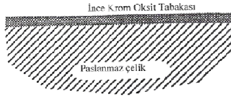
Şekil 2.2. Paslanmaz çelik yüzeyinde oluşan koruyucu krom oksit tabakası [58]
