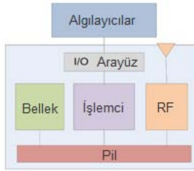
Şekil 2. 2. Genel Algılayıcı Düğüm Mimarisi [10]
