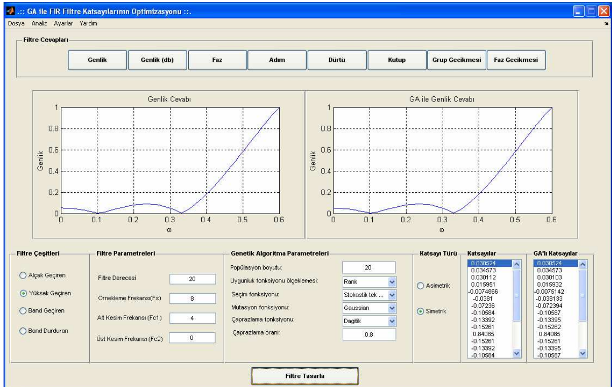
Şekil 5. 14. Simetrik yüksek geçiren FIR filtrenin katsayıları optimizasyonu
