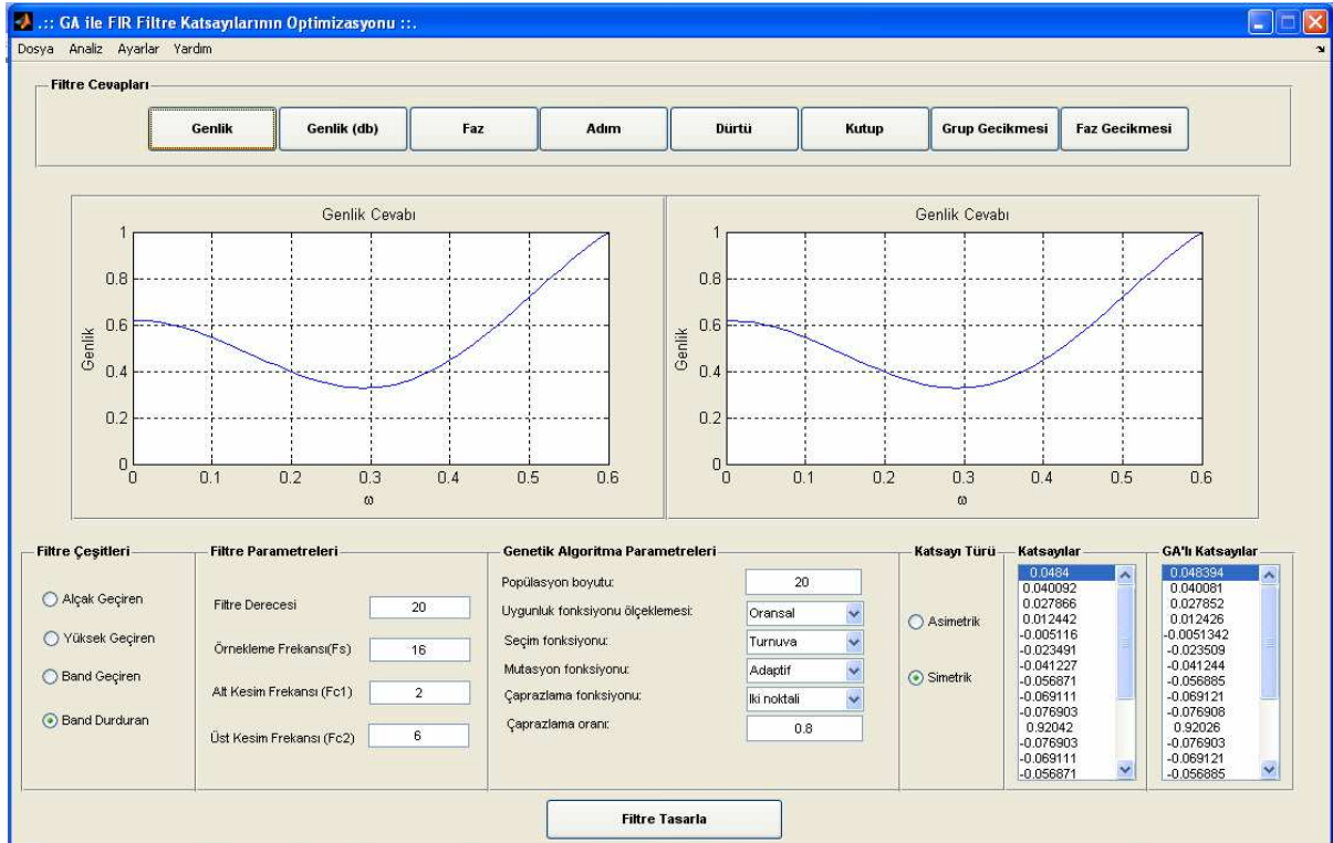
Şekil 5. 20. Band durduran FIR filtrenin simetrik katsayılarının optimizasyonu
