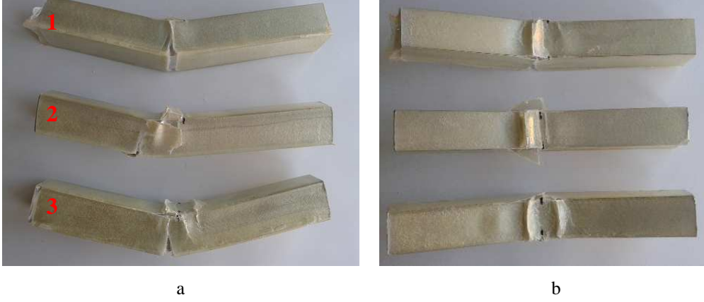
Şekil 6.16 4 kat CE ve kestamit takviyeli kirişin yandan (a) ve üstten görünümü(b)
