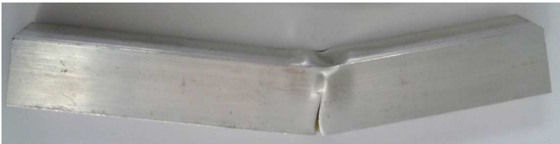
Şekil 6.8. Kısa kestamit (70mm) takviyeli kirişte oluşan hasarın görüntüsü
