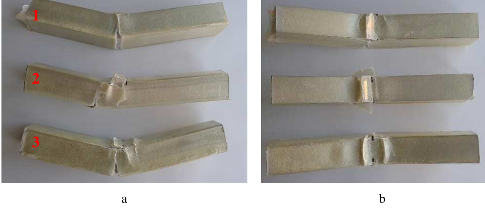
Şekil 6.18. 6 kat CE ve keşamit takviyeli kirişin yandan (a) ve üstten görünümü (b)
