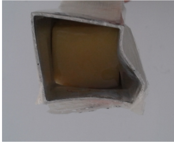
Şekil 6.14. 2 kat cam elyaf ve 210 mm kestamit takviyeli kirişte mesnet tarafından oluşturulan hasar
