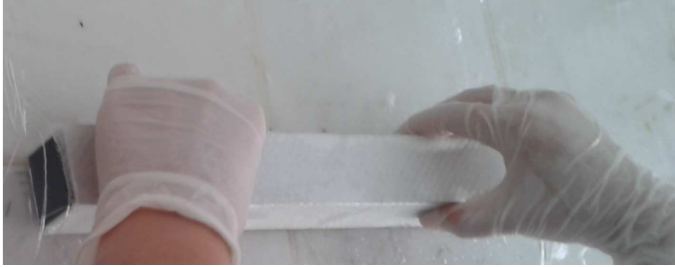
Şekil 5.3. El yatırması yöntemiyle numunenin hazırlanması
