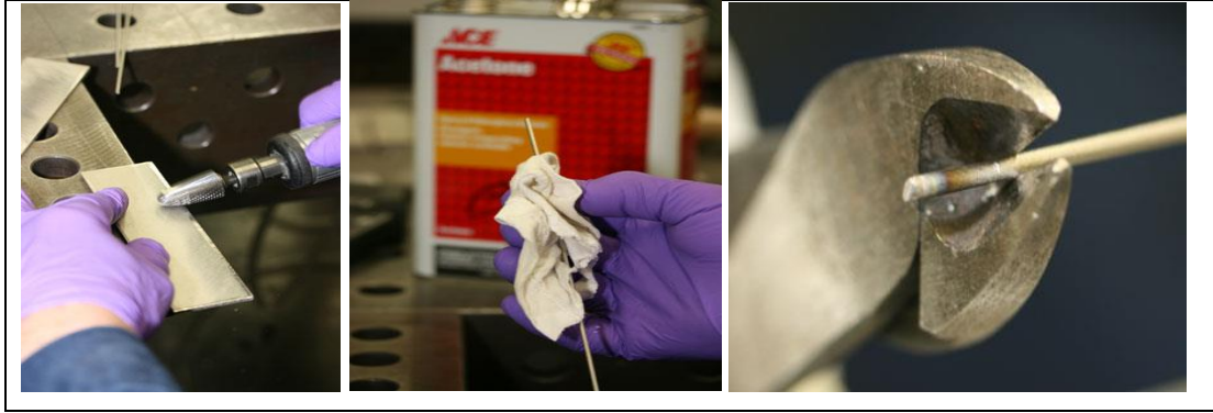
Şekil. 3.2. Kaynak öncesi ve sırasında temizlik [27]
