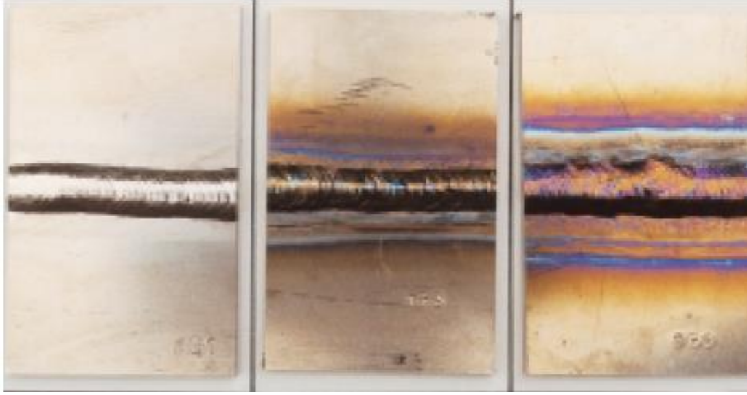
Şekil. 2.7. Koruyucu gaz oranlarının değiştirilmesi ile elde edilen kaynak dikişleri [20]
