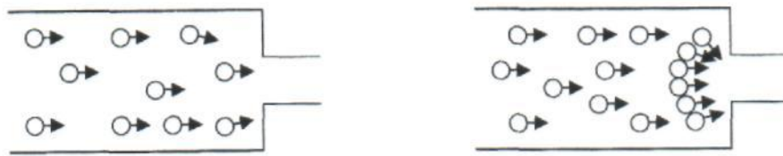
Şekil 2.5 Agregaların kemerlenme oluşturma mekanizması
