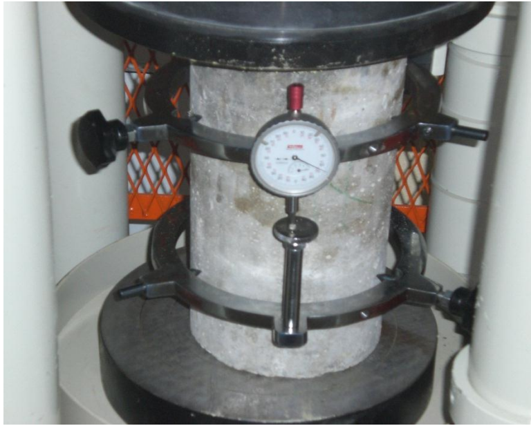
Şekil 3.1. Statik elastisite modülü deneyi ve ölçüm çerçevesi
