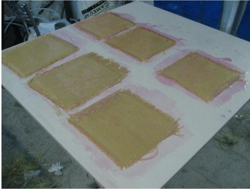
Şekil 2.3. Epoksi uygulanmış Kevlar numuneleri [11]
