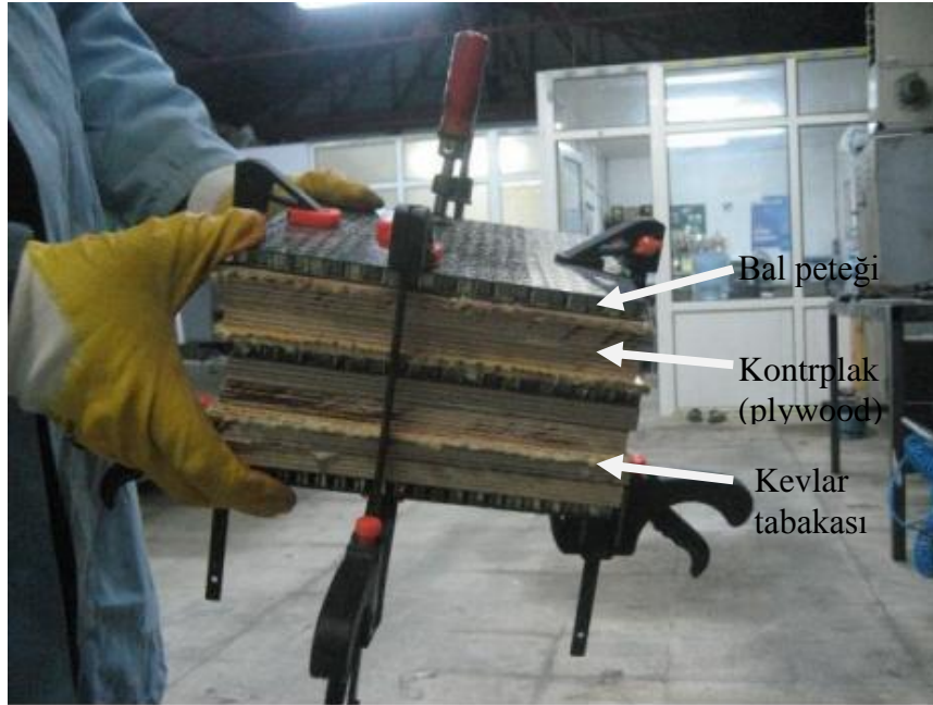
Şekil 2.4. Hazırlanan numunelerin sıkıştırılması [11]
