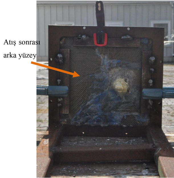
Şekil 2.22. Karbon fiber- Kevlar-çelik tel numunesinin atış sonrası görünüşü
