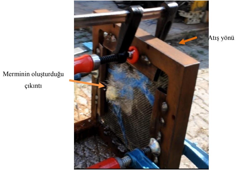
Şekil 2.25. On ikinci numunenin atış sonrası görünüşü
