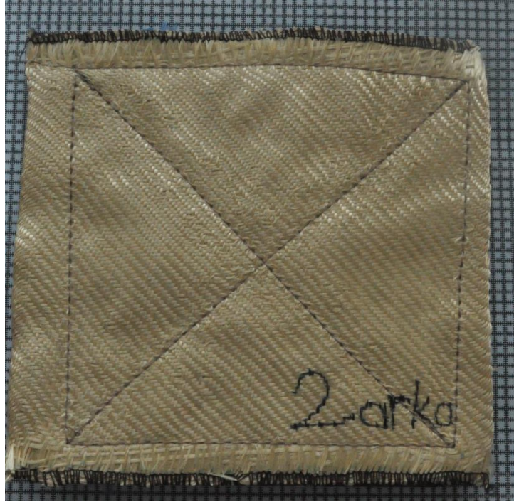
Şekil 2.8. On kat Kevlar kumaşı ile hazırlanan tabaka
