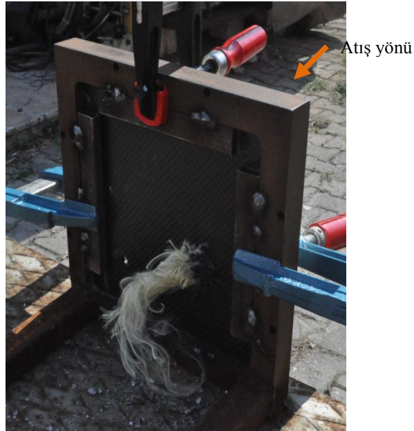
Şekil 2.21. Kevlar- karbon fiber numunesinin atış sonrası görünüşü
