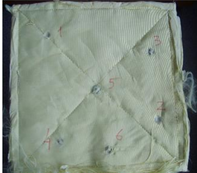
Şekil 1.4. Twaron kumaşı üzerine yapılan balistik deney [21]
