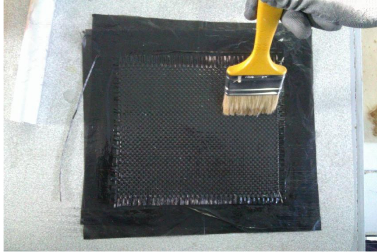
Şekil 2.5. Karbon fiber katmanlarının hazırlanması
