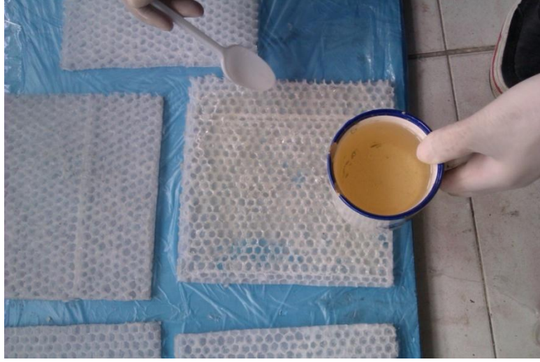
Şekil 2.7. Polipropilen bal peteğinin epoksi karışım ile doldurulması
