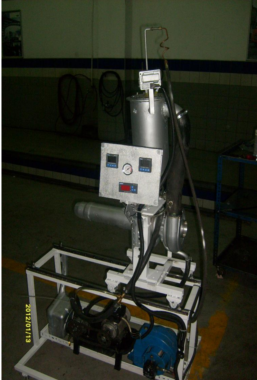
řekil 4.14. Yanma odasına dıřtan kaynatılan hava borusu
