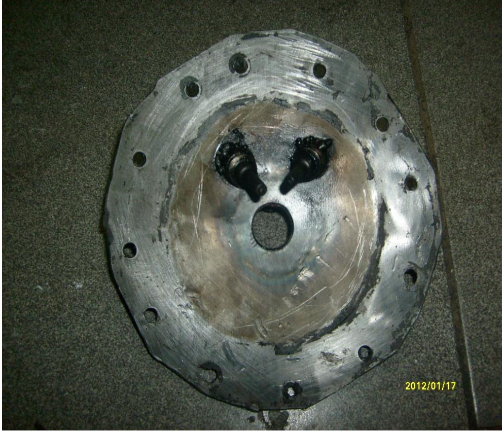
Şekil 4.16. Alev t p  kapađı  zerine monte edilmiř ateşleme bujileri
