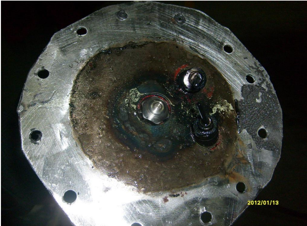
Şekil 4.21. Alev tüp kapađına monte edilmiř yakıt enjektörü
