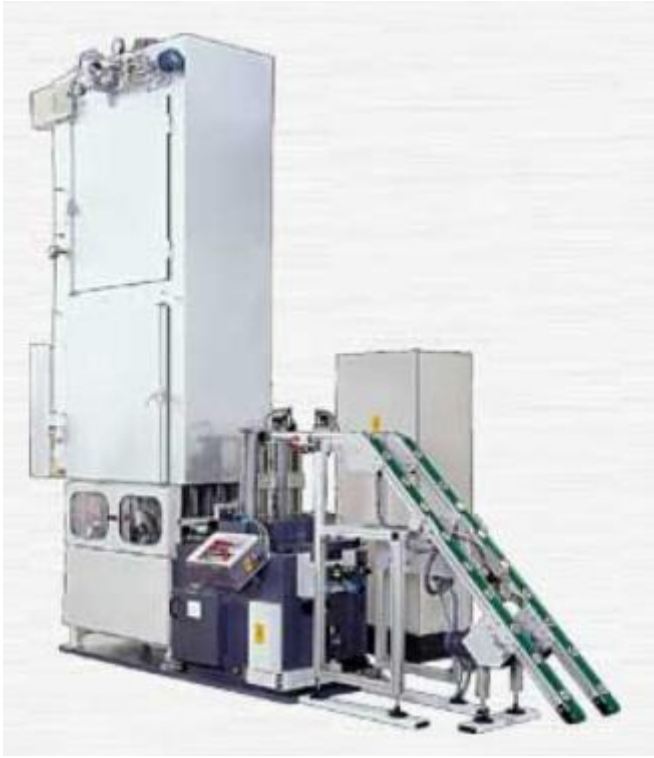
Şekil 2. 9. Contalama makinesi ve dikey fırın görüntüsü
