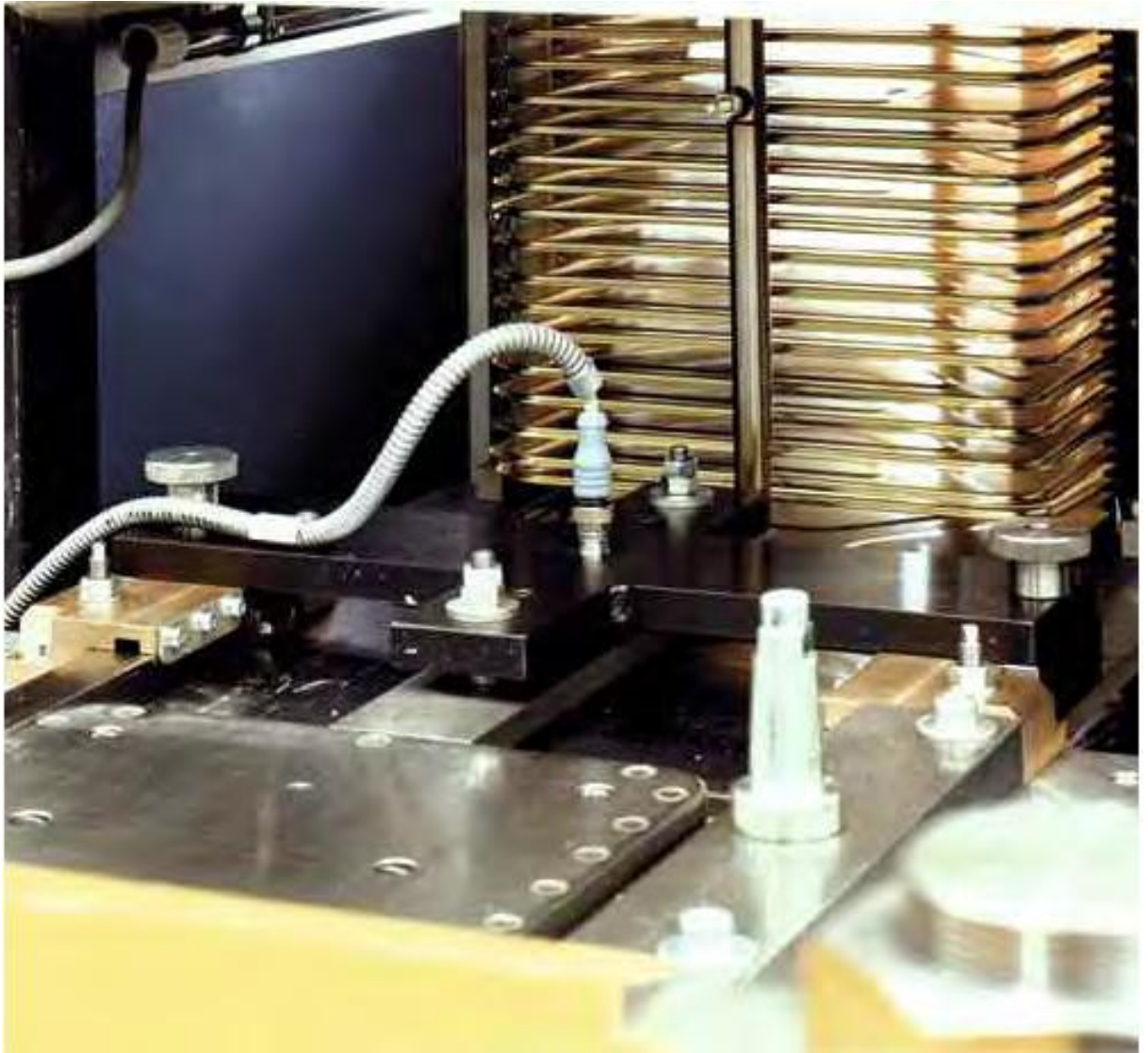
Şekil 2. 12. Köşeli kapaklarda dik fırında conta kuruma resmi
