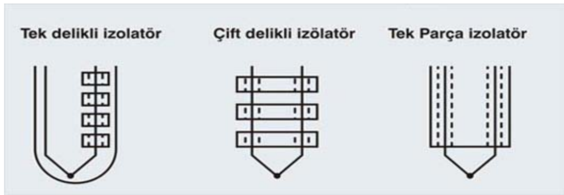
Şekil 3.8. Termokopulun izole edilmesi [46]
