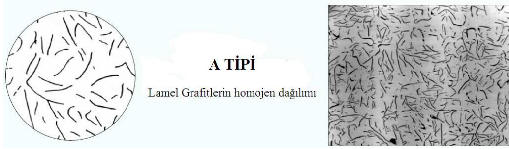
Şekil 1.4. ASTM' ye göre A-Tipi grafit şekli [6]
