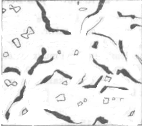
Şekil 2.3. Gri dökme demirde manganez - Sülfür enklüzyonları (açık gri renkli) (Dağlanmamış 200X)
