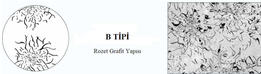
Şekil 1.5. ASTM' ye göre B-Tipi grafit şekli [6]
