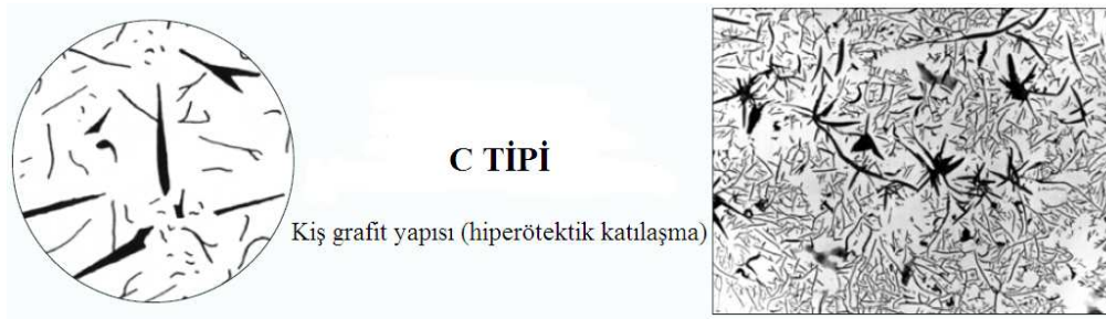
Şekil 1.6. ASTM' ye göre C-Tipi grafit şekli [6]
