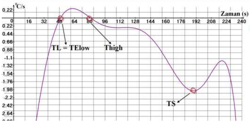
Şekil 6.14. M1, M2, M3, M4 numunelerinin soğuma hızı eğrileri
