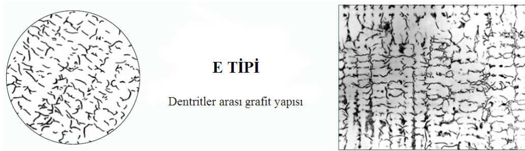
Şekil 1.8. ASTM' ye göre E-Tipi grafit şekli [6]
