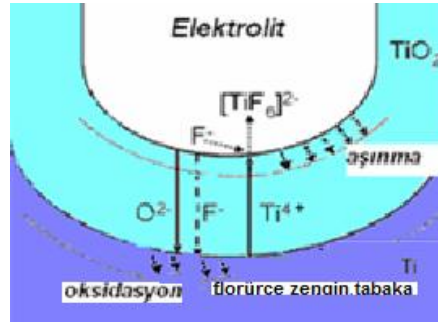
Şekil 3.7. Florür iyonu içeren (nanotüp büyümesiyle sonuçlanır) elektrolitlerde anodizasyonun şematik gösterimi [7]
