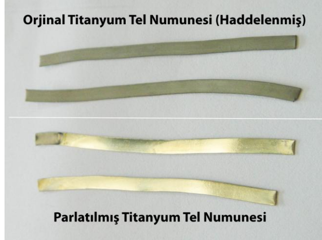
Şekil 4.1. Elektropolisaj yöntemiyle parlatılmış titanyum tel numuneleri
