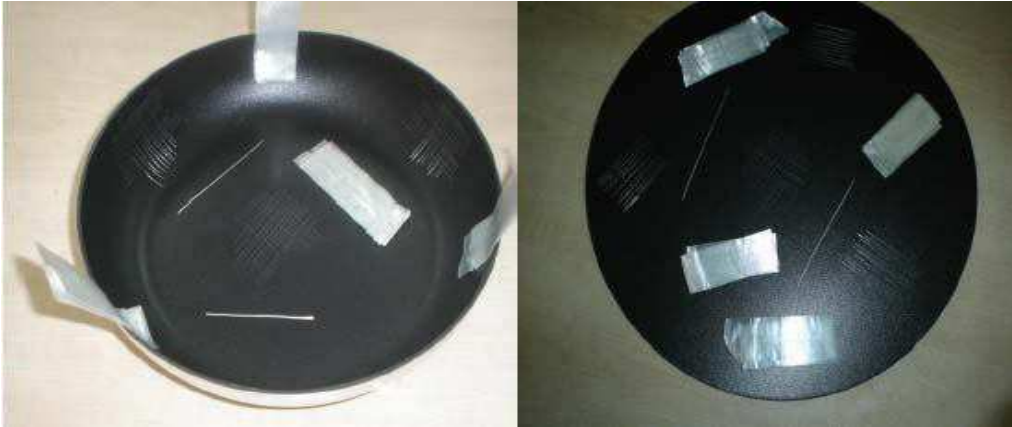
Şekil 3.8. Kareleme ve tırnaklama testi uygulaması [4]
