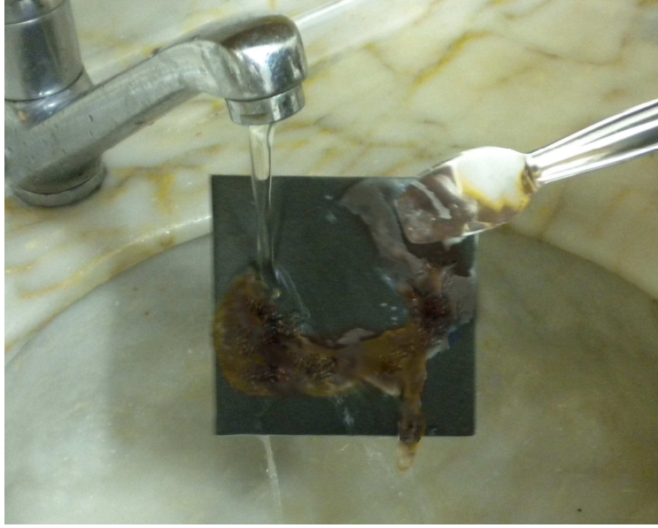
Şekil 4.42. Test sonrası nano gümüş takviyeli teflon numune (6 dk kütleme) yüzey temizleme
