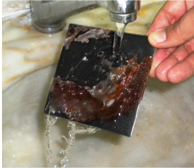
Şekil 4.43. Test sonrası nano gümüş takviyeli teflon numune (8 dk kütleme) yüzey temizleme
