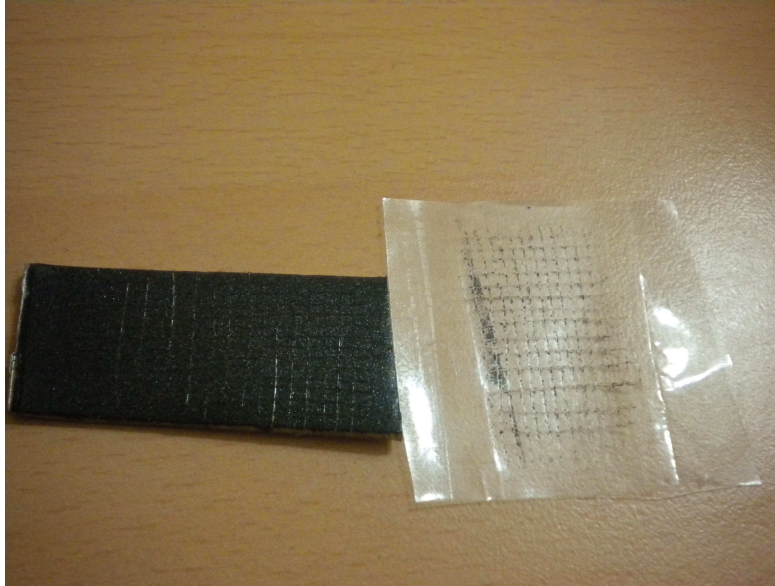
Şekil 4.30. Test sonrası takviyesiz referans numune ve yüzeyden kopan teflon partikülleri
