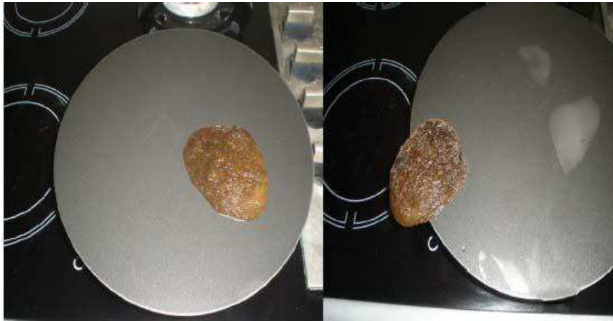
Şekil 3.7. Yapışmazlık (süt) testi uygulaması [4]
