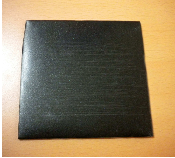
Şekil 4.36. Aşınmış nano gümüş takviyeli teflon numune kaplama yüzeyi
