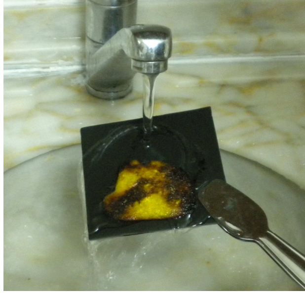
Şekil 4.45. Yumurta testi sonrası yüzey temizleme
