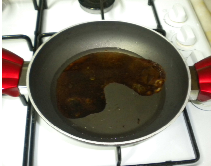
Şekil 4.38. Test sonrası takviyesiz referans teflon numunesi yanmış yüzey görüntüsü
