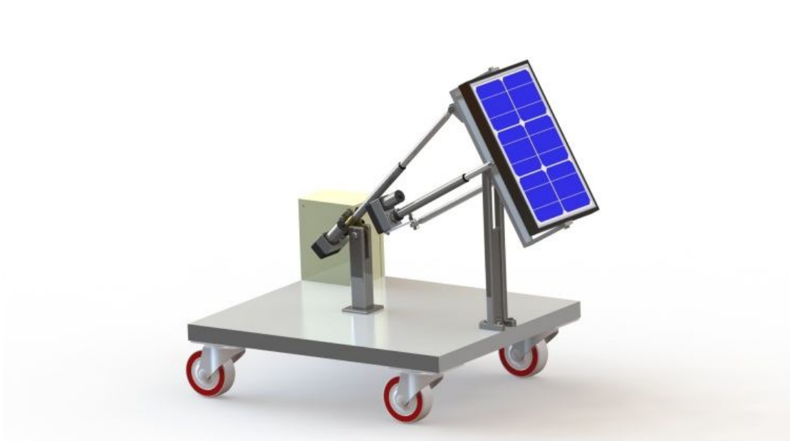
Şekil 4.1. İki eksen izleyicili sistem Solidworks tasarımı: Tasarım-1
