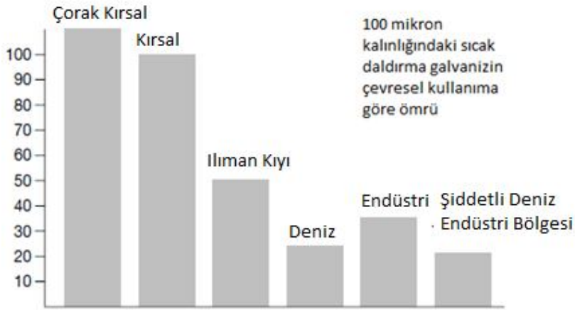
Şekil 4.5. 100 mikron kalınlığındaki sıcak daldırma galvanizin çevresel ömrü
