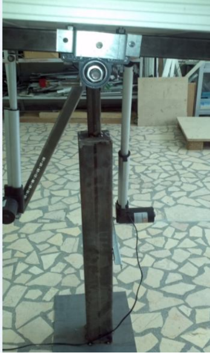
Şekil 6.5. Montaj aşaması 5- aktüatörler
