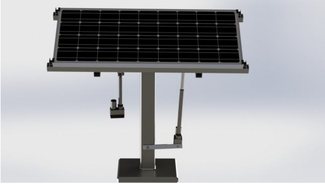
Şekil 4.4. İki eksen izleyicili sistem Solidworks tasarımı: Tasarım-2
