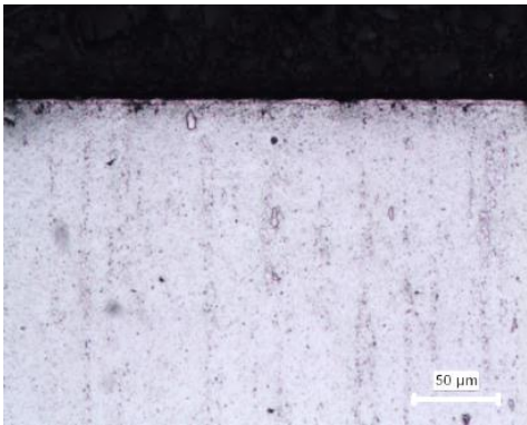
Şekil 7.3. 1 saat süre ile kaplama işlemine tabii tutulan AISI M2 çeliği için a) katkısız, b)%0.5 Al, c)%1 Al, d) %1.5 Al ve e)%2Al oranlarda alüminyum içeren Nb-N ve Nb-Al-N esaslı kaplamaların optik mikroyapı görüntüleri
