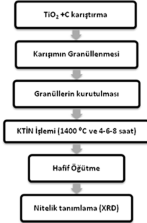
Şekil 5.10. KTİN işlemi ile TiN tozu üretimi için iş akış şeması
