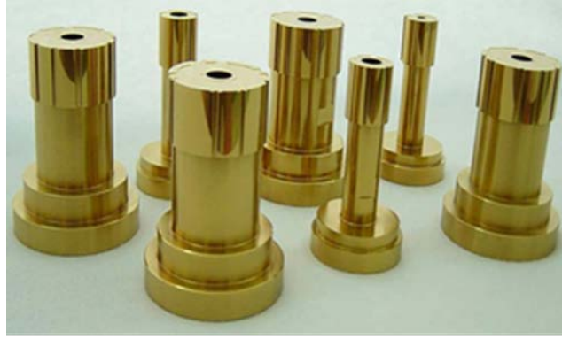
Şekil 3.7. TiN kaplı zımbalar NanoShield PVD [16]
