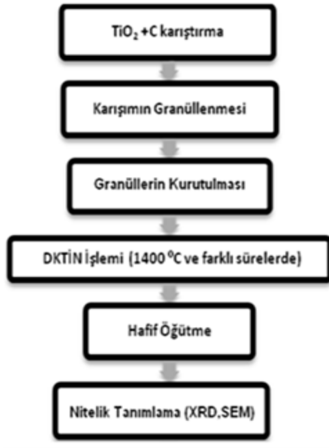
Şekil 5.15. DKTİN işlemi ile TiN tozu üretimi için iş akış şeması
