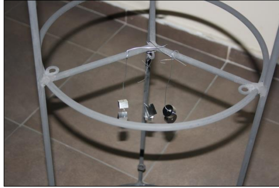
Şekil 4.8. Gaz nitrürleme deneylerinde kullanılan numunelerin işlem öncesinde numune sepetindeki dizilimi
