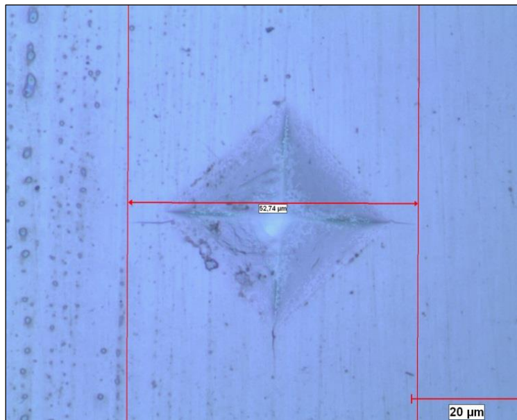
Şekil 4.12. Gaz nitürlenmiş 34CrAlNi7 çeliğinde vickers indantasyon tekniği ile oluşturulan sertlik izi, sertlik izi çevresinde oluşan radyal çatlaklar ve çatlak boyunun ölçümünü gösteren optik mikroskop görüntüsü (1000x)
