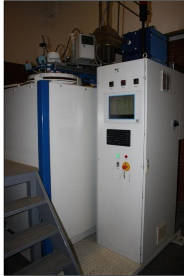
Şekil 4.2. Gaz nitrürleme deneylerinin gerçekleştirildiği K_N -nitrürleme potansiyeli kontrollü gaz nitrürleme fırını
