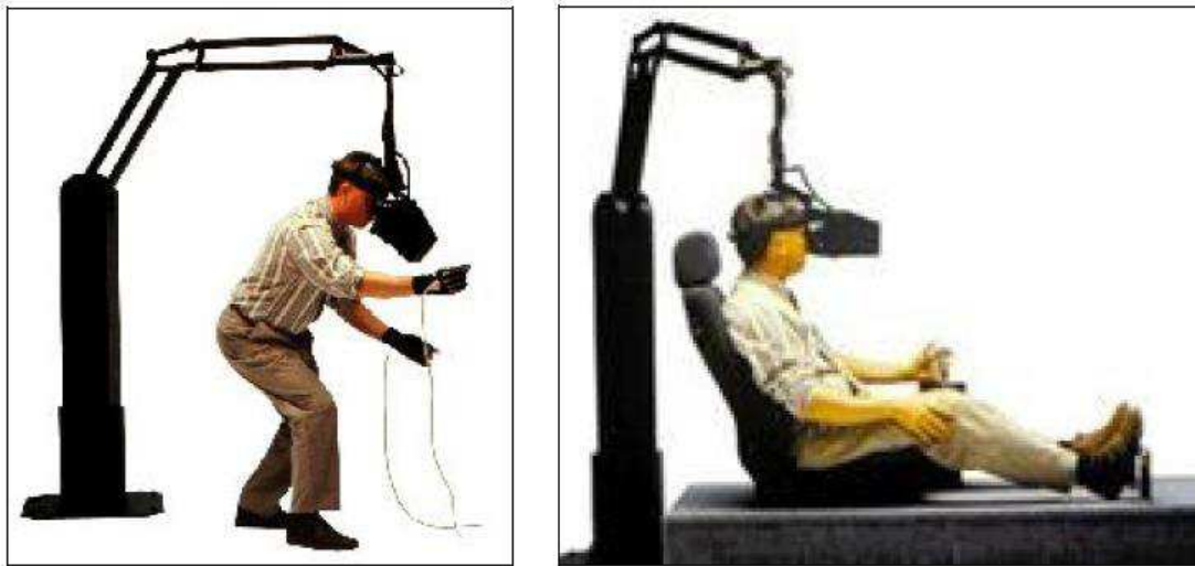
Şekil 3.2. Mekanik algılayıcı örnekleri [28]
