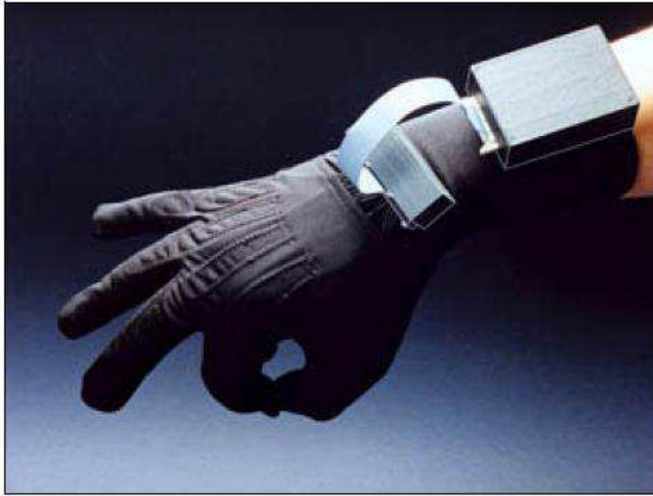
Şekil 3.3. Veri eldiveni üzerine yerleştirilmiş elektromanyetik algılayıcı [28]
