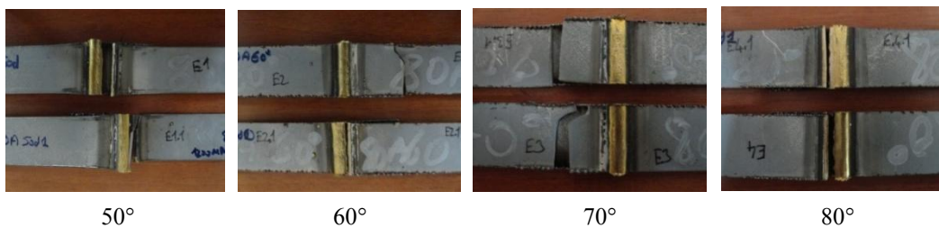
Şekil 6.59. Farklı torç açılarındaki lehimlenmiş numunelerin çekme deneyi sonrası fotoğrafları.
