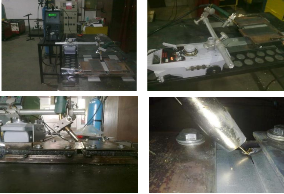
Şekil 5.2. MIG-lehimleme işleminin yapıldığı makine ve sekator.
