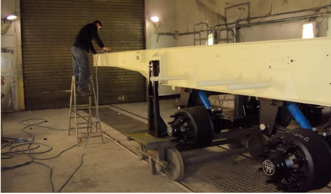
Şekil 5.34. FWR zımpara operasyonu
