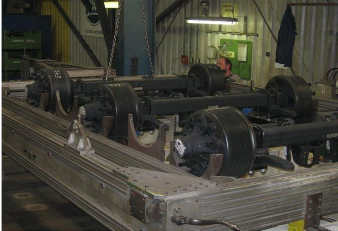
Şekil 5.38. Mevcut durumda FWR aks montajı
