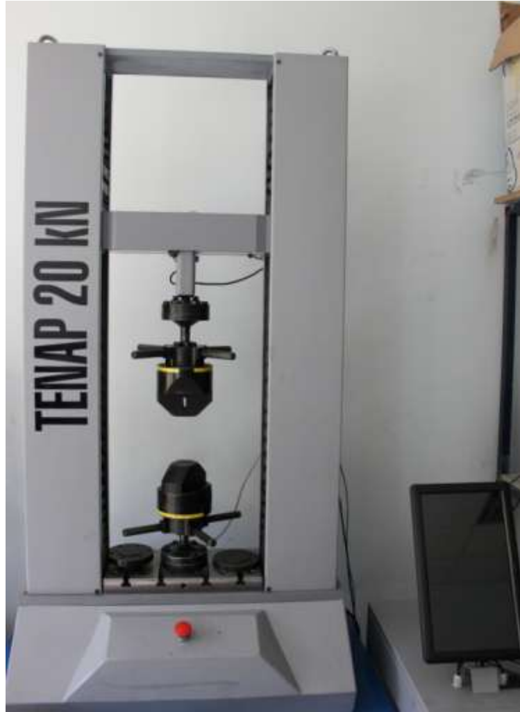
Şekil 5.7. Servo motor kontrollü, vida tahrikli ve 40 kN kapasiteli TENAP çekme makinesi
