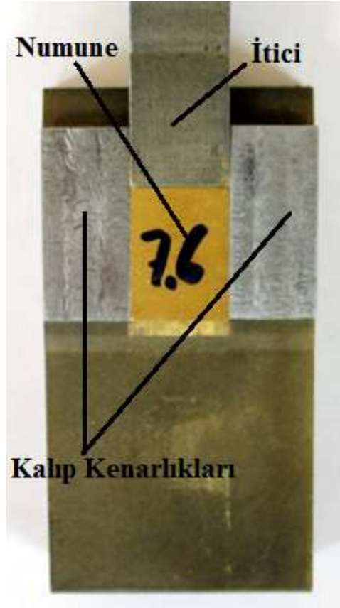
Şekil 5.9. Kalıp kenarlıkları, itici ve numunenin kalıp üzerindeki yerleşimi
