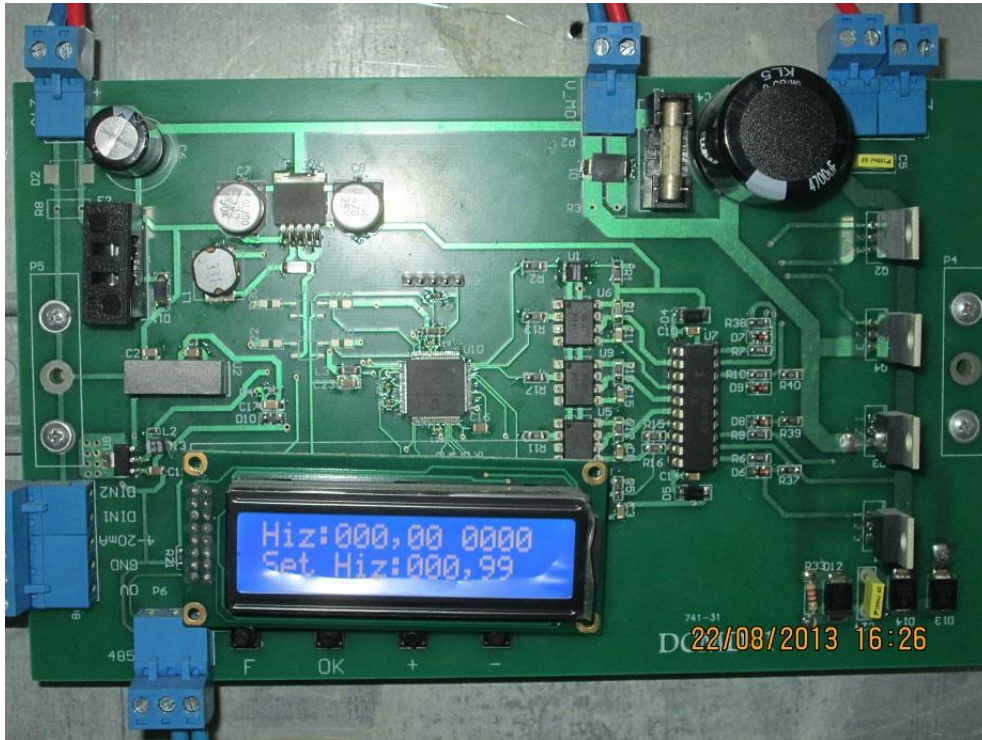
Şekil 5.17. PID Kart Devresi Üstten Görünüşü
