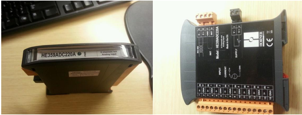
Şekil 4.5. 20mA Analog Giriş Modülü
