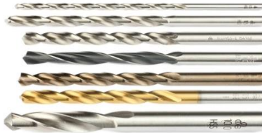
Şekil 3.8. Farklı malzemede ve boyutlarda üretilmiş matkap uçları (Kaynak, 2013).
