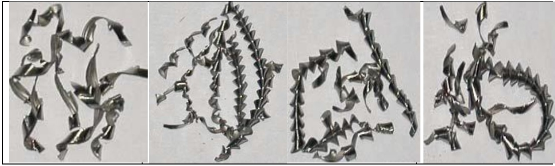
Şekil 3.13 ilerleme miktarında kesme hızına bağlı olarak delinen deliklerden alınan talaş örneklerindeki değişim
